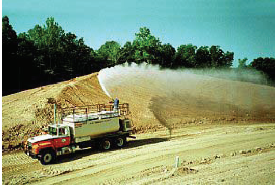
Şekil 2.9: Cebeci Taş Ocaklarında toz oluşumunu önlemek amacıyla yapılan sulama [6]
