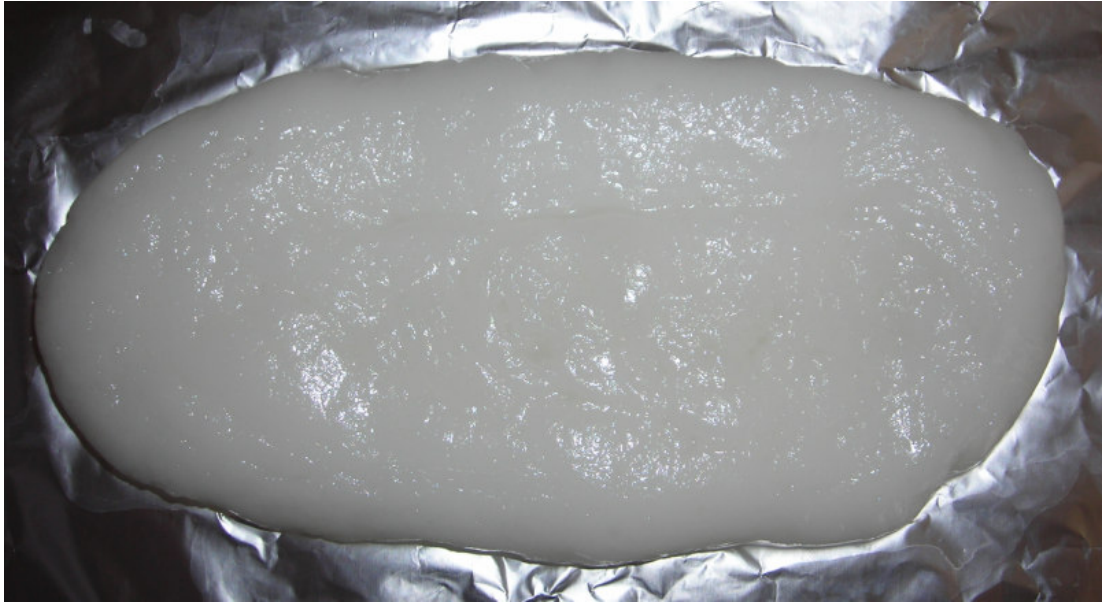
Resim 3.1. Elde edilen PVA- borik asit jeli
