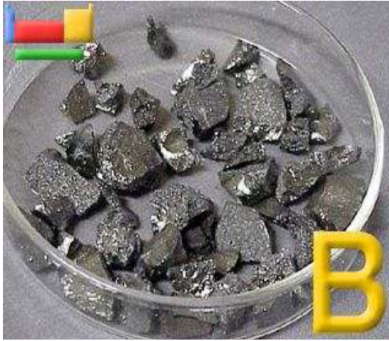
Şekil 2.3. a. Elementel borun görünüşü b. Bor'un kristal yapısı [2]
