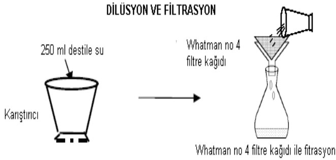
Şekil 3.18. Dilüsyon ve filtrasyon aşaması
