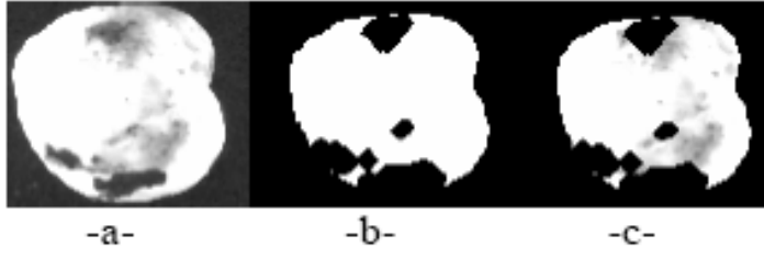
Şekil 3.13. a) Fındığın 550 nm dalga boyundaki görüntüsü, b) maske, c) maskelenmiş görüntü (Kalkan ve Yardımcı, 2008)
