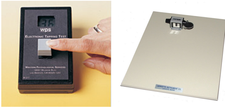
Şekil 1.1 Dijital ve Analog parmak vuru testi cihazları (Mitrushina et al. 1989).
