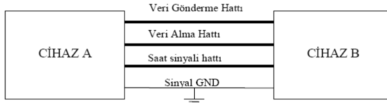
Şekil 2.33 Senkron seri iletişimin basit bağlantı şeması (URL-1 2009).
