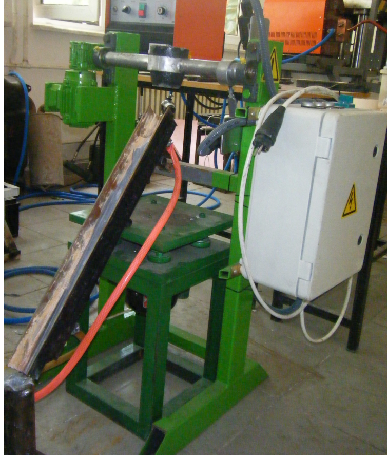
Şekil 6.12. Vibrasyon altında eğimli soğutma plakasında döküm cihazı
