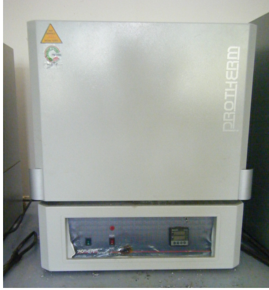
Şekil 6.10. Ergitmenin yapıldığı rezistanslı fırın
