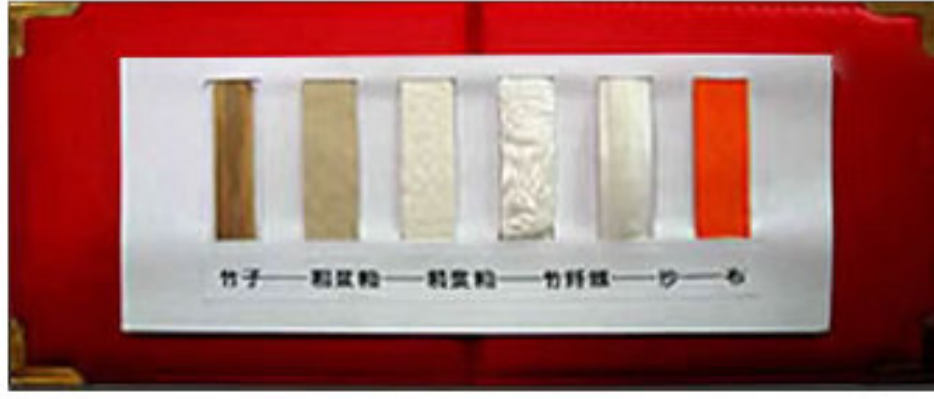
Şekil II.2. Bambu Kumaş Üretim Akışı : bambu – kalın hamur – ince hamur – bambu lifi – bambu ipliği - kumaş
