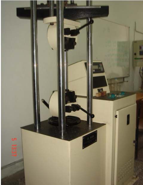
Şekil 3.4. Vida tutma deneyi makinesi ve profili
