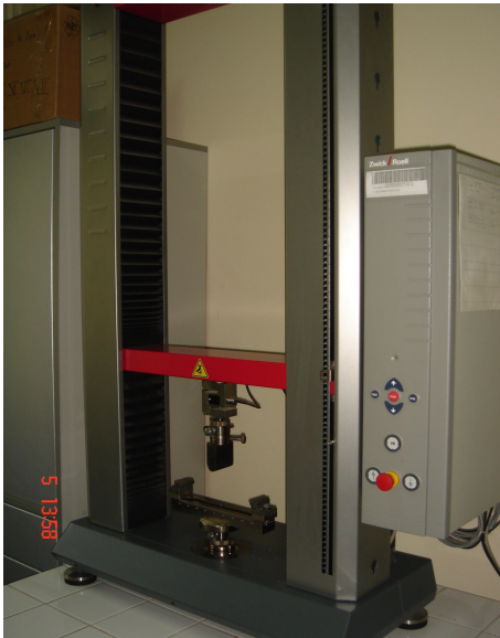
Şekil 3.1. Eğilme direncinin yapıldığı deney makinesi
