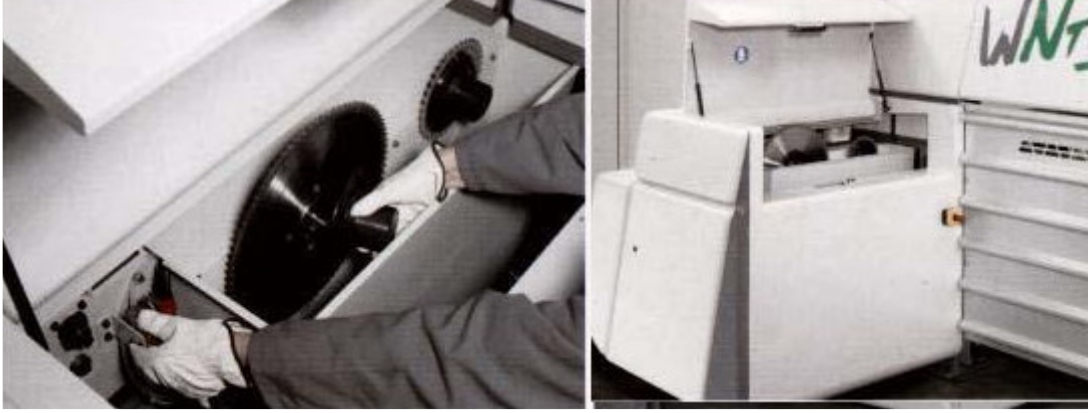
Şekil 1.12. Testere değiştirme işlemi.
