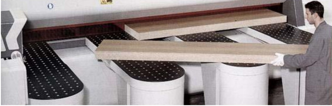
Şekil 1.14. Hava yastıkları(salyangoz motorlu olup mdf (Medium Density Fiberboard) parçalarının hareketini kolaylaştırır).
