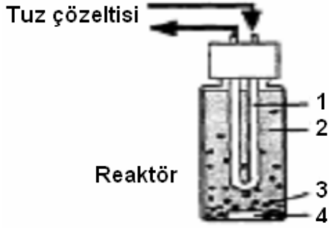
Şekil 2.23 Doymuş tuz çözeltileri ile sürekli a_w kontrolü (1; Silikon tüp, 2; Tepkime ortamı, 3; Enzim, 4; Magnet)
