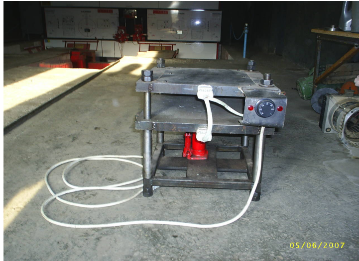
Şekil 7. Kompozit Malzemeleri Üretmek İçin Kullanılan Sıcak Pres.
