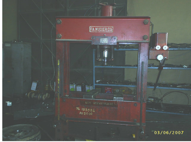
Şekil 6. Kompozit Malzemeleri Üretmek İçin Kullanılan Soğuk Pres.
