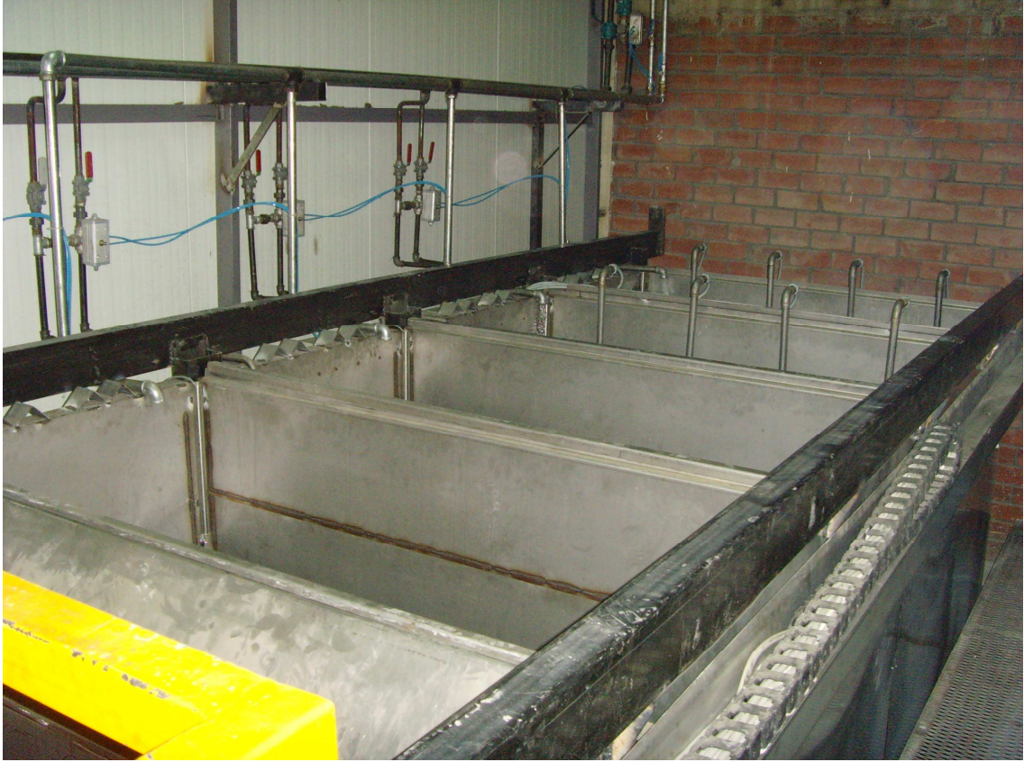
Şekil 1.6 Yıkama Makinasının Havuz Bölmeleri
