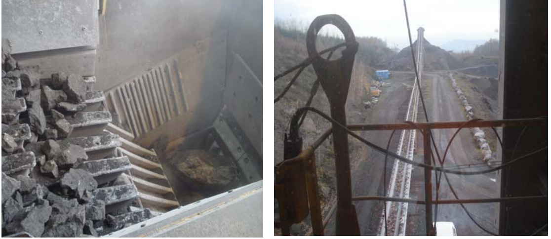
Resim 2.7. Sabit kırıcıdan görüntüler ve kırıcıdan çıkan malzemenin bantla nakli (Ateş, 2008).
