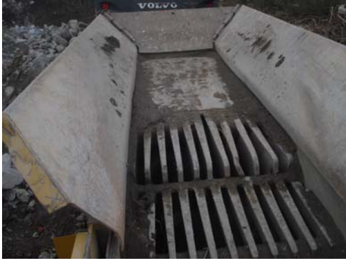
Resim 2.3. Kırıcının besleme ağzının görüntüsü(Ateş, 2008).
