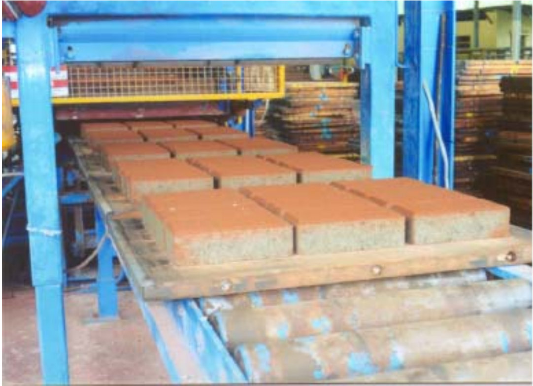
Resim 3.1. Geri dönüştürülmüş agregadan kaldırım bloğu üretimi (Poon, 2002).
