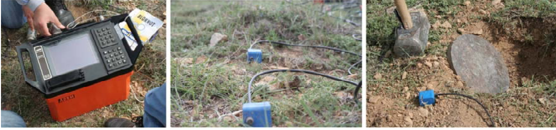
Şekil 4.1 Sismik yöntem için gerekli donanımlar: sismik kayıtçı, jeofon, levha ve balyoz
