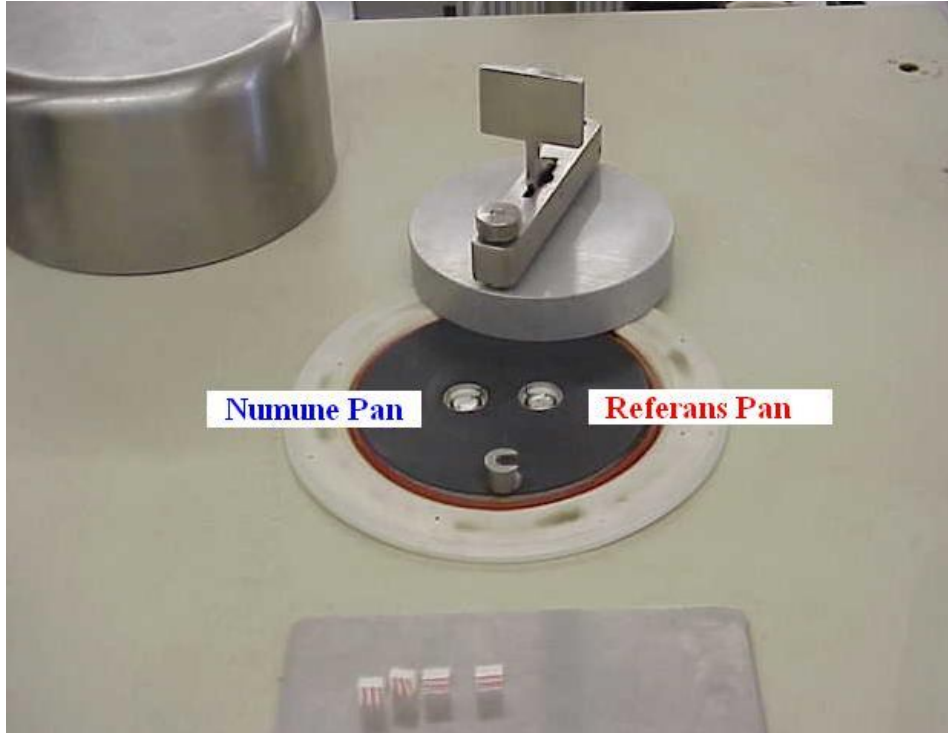
Şekil 2.23 Polimer numune ve referans için penlerin cihazdaki yerleşimi
