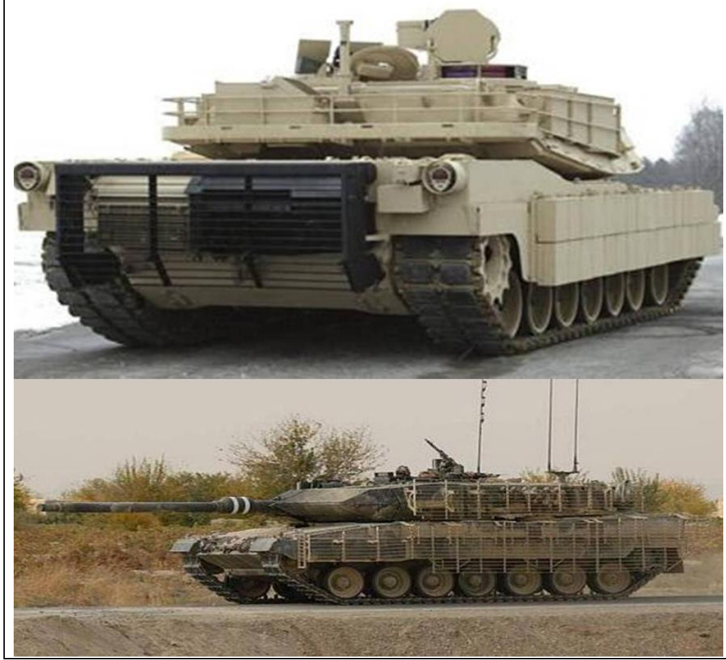
Şekil-38: Reaktif Zırh Panelleri ve Metal Kafesler
