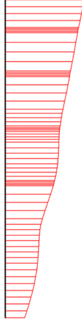
řekil 4.18 Duvardaki yatay yer deęiřtirme (plak no: 1) - En yksek deęer 37.15 \cdot 10^{-3} \text{ m}
