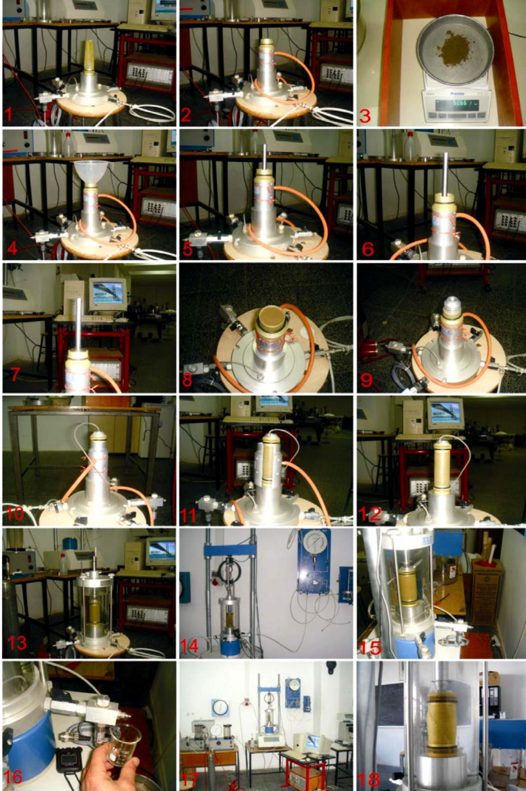
Şekil 3.13. Örselenmiş numuneden üç eksenli basınç deney numunesi hazırlanması
