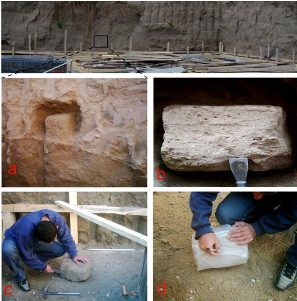
Şekil 3.1. Örselenmemiş blok numune alınması
