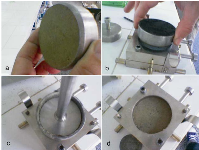
Şekil 3.7. Deney numunesinin numune çıkarıcı kalıptan kesme kutusuna aktarılması
