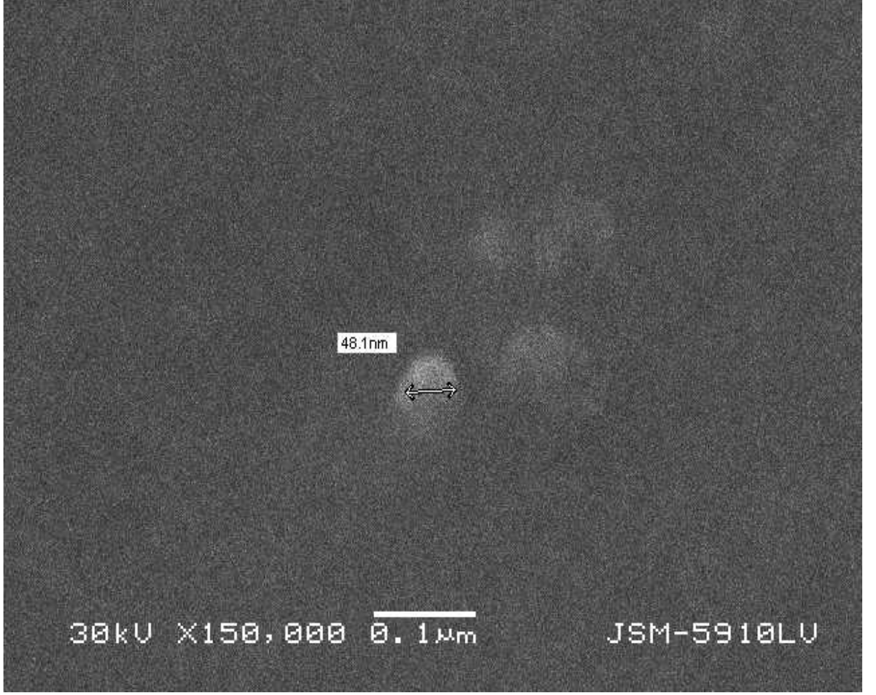
Şekil IV.21: SAE 9 Örnek Kodlu Filmin X 150,000 Büyütmedeki SEM Görüntüsü
