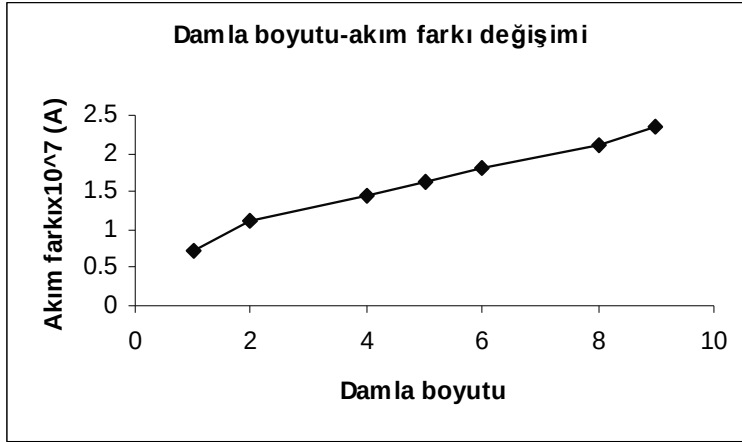
Şekil 4.23. AdSKDV yöntemi ile fosfat tamponunda (0,30 M pH 9,00) 2,36 \times 10^{-8} M 3-NT için damla boyutu ile akım farkı değişimi
