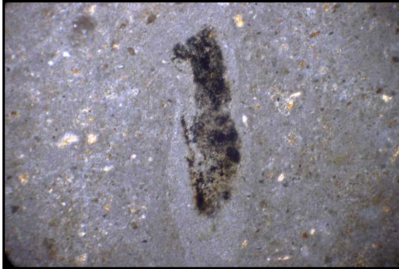
Şekil 4.9 amurtaşı numunesinin ince kesitinde gözlenen kömür oluşumları
