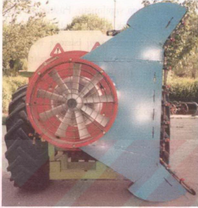
Şekil 3.5. Makinenin yeni hava yönlendirme ünitesi ve püskürtme sistemi monte edildikten sonraki görünümü
