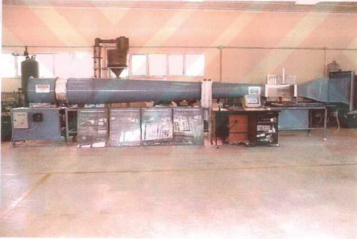
Şekil III.13 Dizayn edilen hava tünelinin genel görüntüsü
