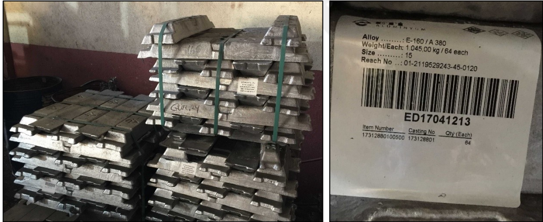
Şekil 2.5. Pompa gövdesinin basınçlı dökümünde kullanılmak üzere eritmeye bekleyen alüminyum külçeleri
