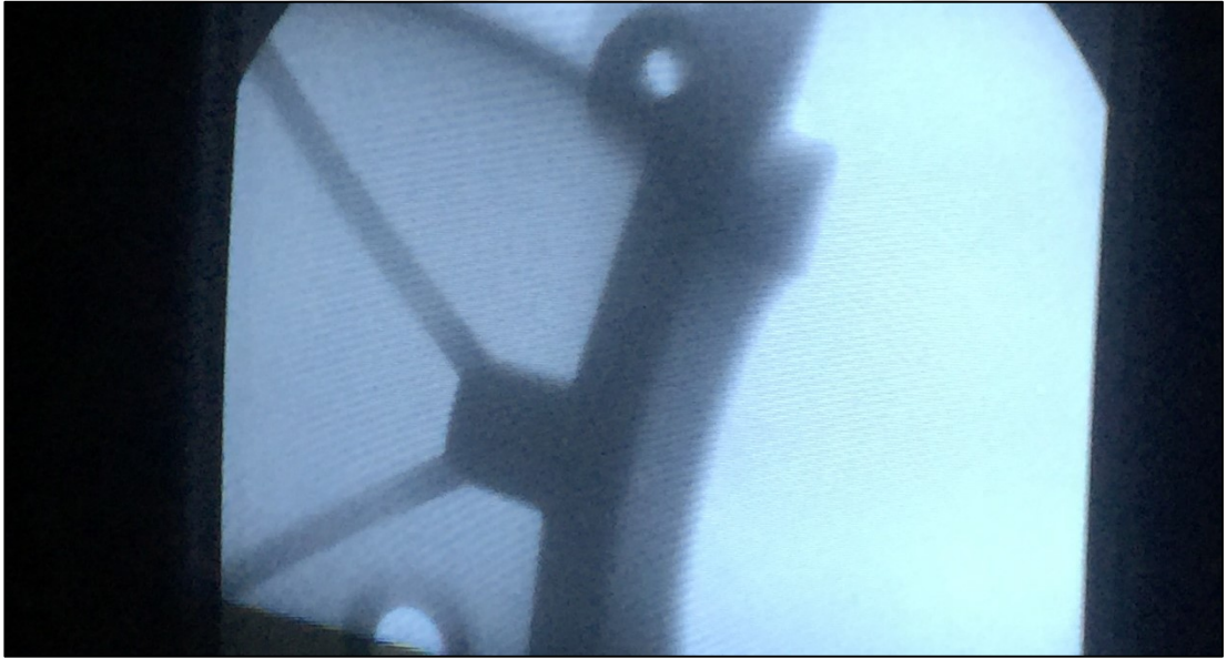
Şekil 2.18. X-ray cihazında pompa gövdelerinin iç yapısının incelenmesi
