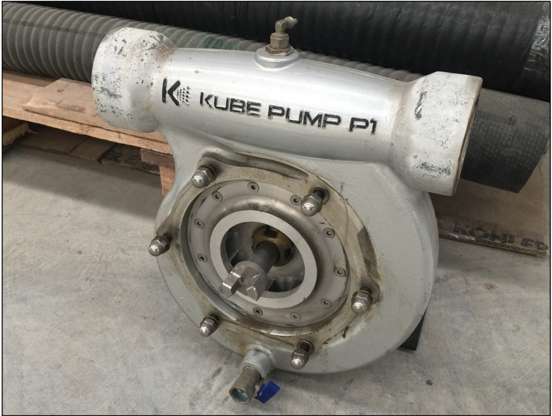
Şekil 2.14. Kum kalıba dökülerek üretilmiş mevcut pompa gövdesi
