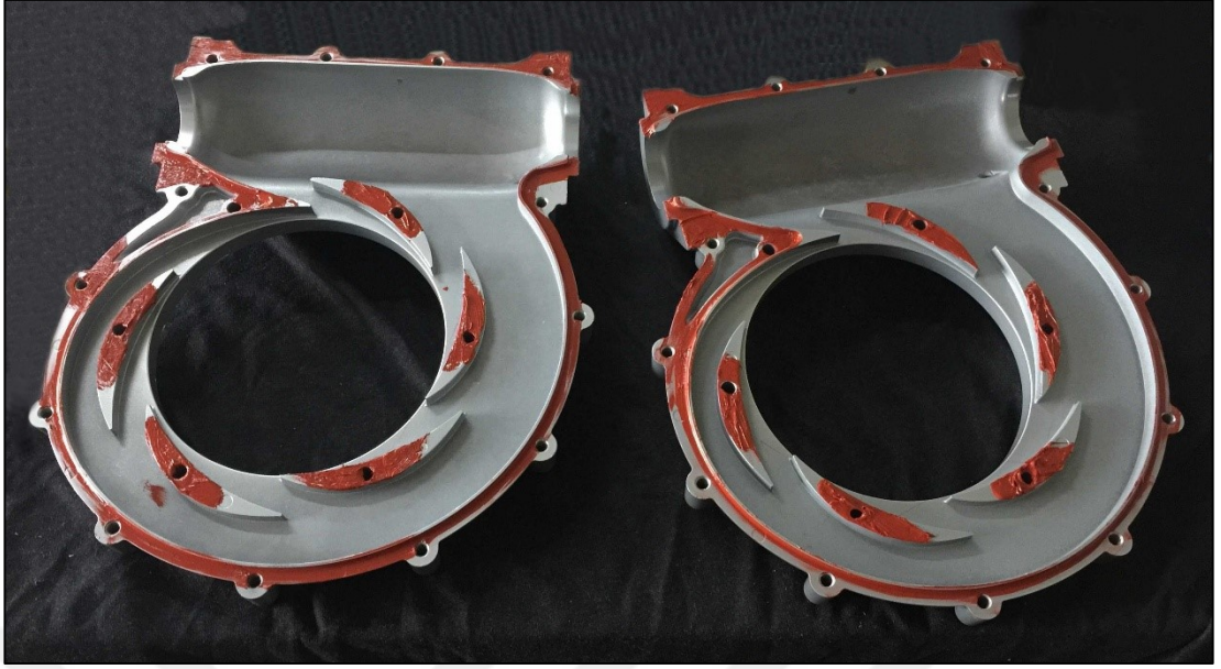
Şekil 2.15. İki parça halinde üretilen pompa gövdelerine montaj öncesinde sıvı conta uygulanması
