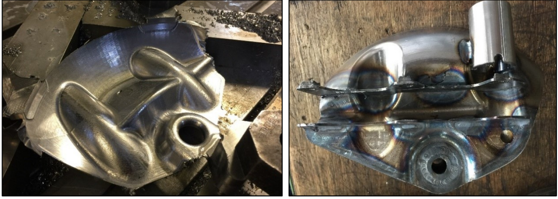
Şekil 3.13. Çamurlukların frezede işlenmesi ve sonrasında kaynaklı hali
