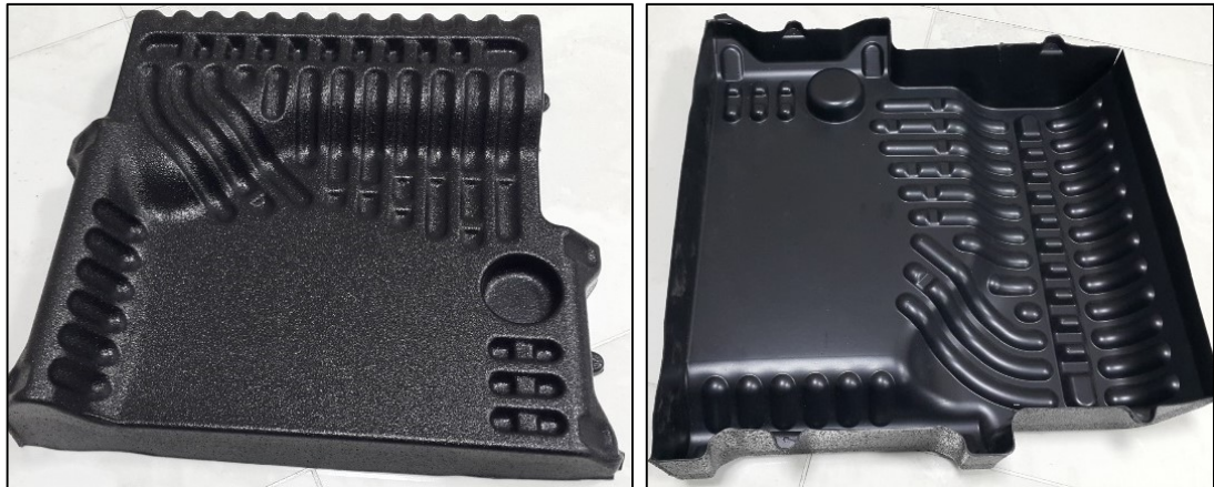
Şekil 4.8. Vakum ve ısı ile şekillendirilmiş üst kaporta kapağının iç ve dış görünüşü
