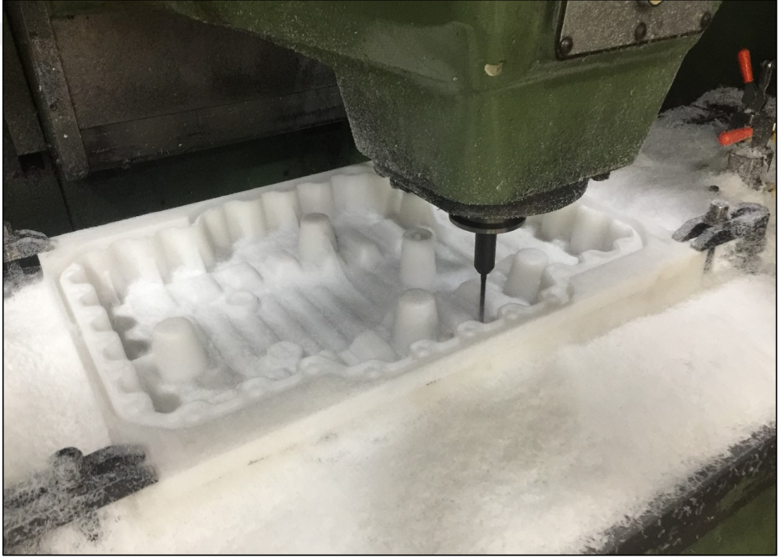
Şekil 3.12. Plastik kaide parçalarının CNC dik işleme merkezinde işlenmesi
