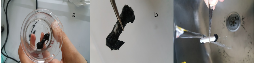
Şekil B.4 Katı ürünlerdeki demirin magnete yapışması
