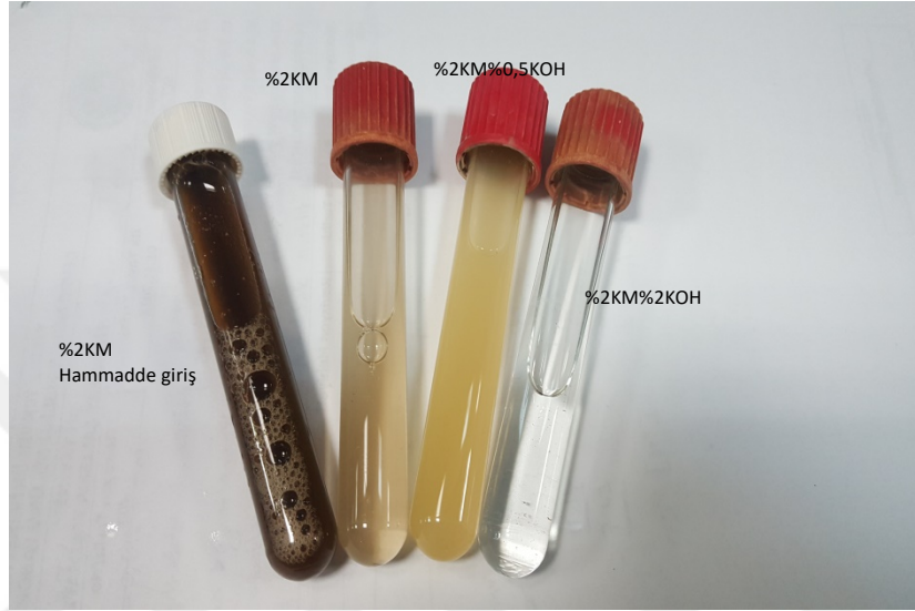
Şekil 5.19 Katalizör ilavesi ile gerçekleştirilen çalışmalar sonucu oluşan sıvı ürünlerin görüntüleri (25 MPa, 650°C, %2 KM, %0,5-2 KOH)
