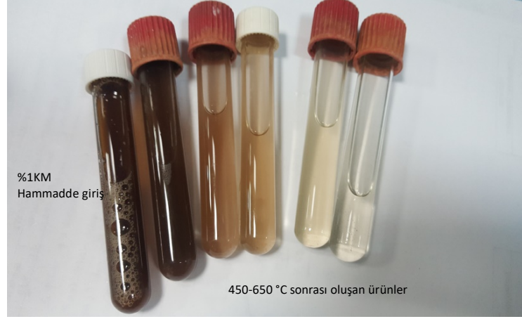
řekil 5.10 Arıtma amurunun farklı sıcaklıklarda süperkritik gazifikasyonu sonucu oluřan sıvı ürünlerin görüntüleri (%1 KM, 25 MPa, 450-650°C)
