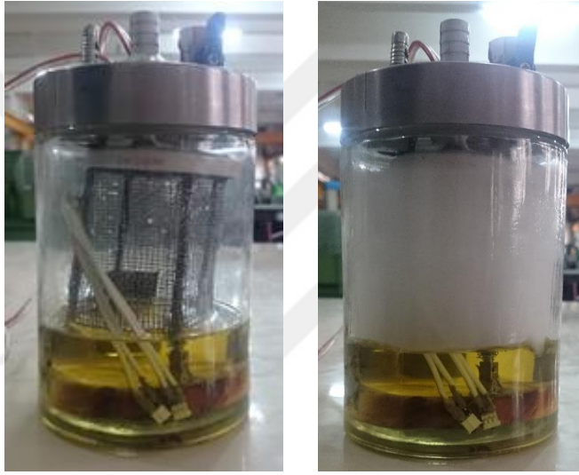
Şekil 2.20. 55 Ultrasonik atomizasyonun başlamadan önce ve başladıktan sonraki görüntüsü
