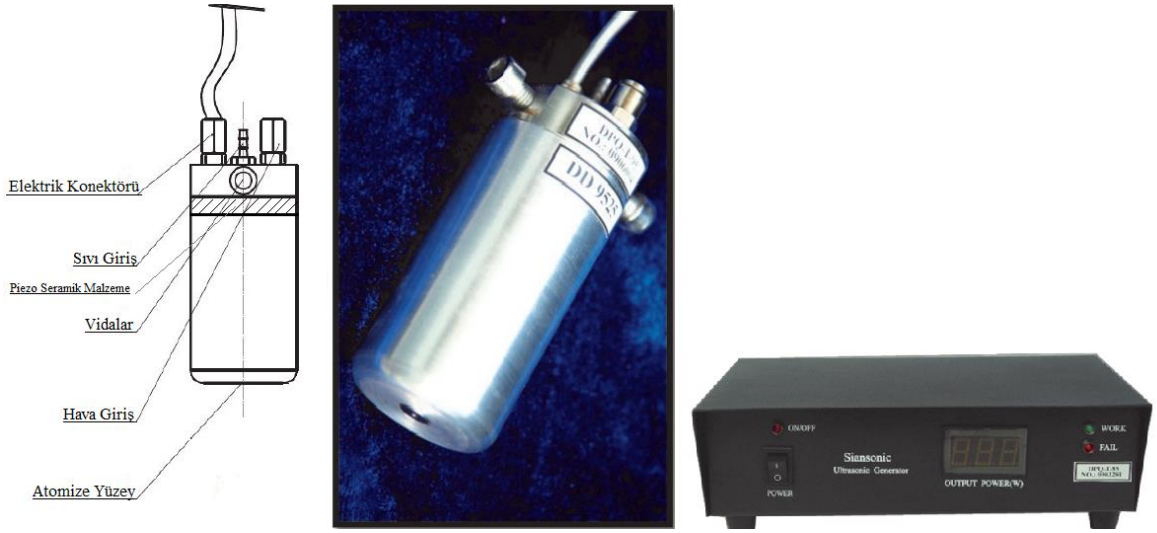
Şekil 1.44. Ultrasonik enjektör şeması, Ultrasonik enjektör, Ultrasonik jeneratör.
