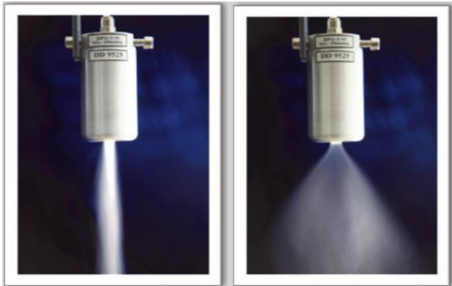
Şekil 1.45. Ultrasesin farklı yönlendirilmesiyle sıvı atomizasyonları.
