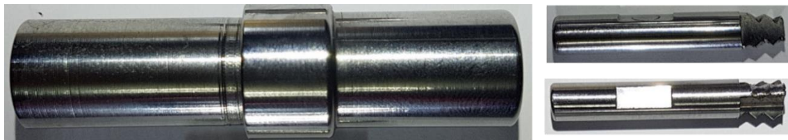
Resim 7.5. İmal edilen genişleyen ve tekrar karıştırıcı profiline sahip karıştırıcı takımlar
