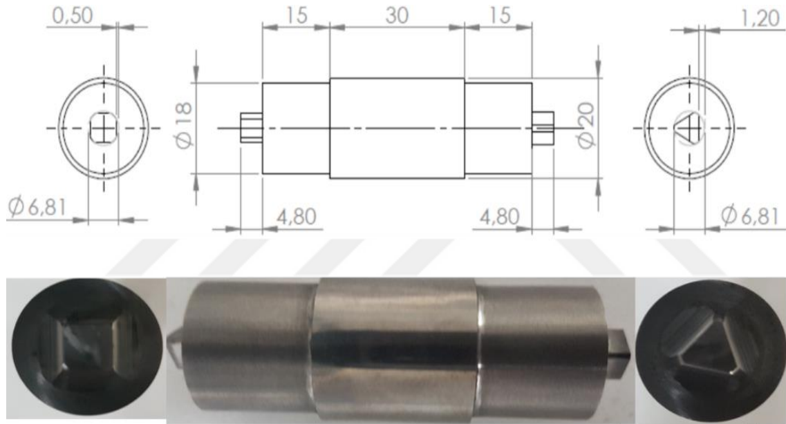
Resim 7.6. Geliştirilmiş ön kaynak işlemleri için ISO K10 kalite karbürden üretilen üçgen ve kare profilli karıştırıcı uç
