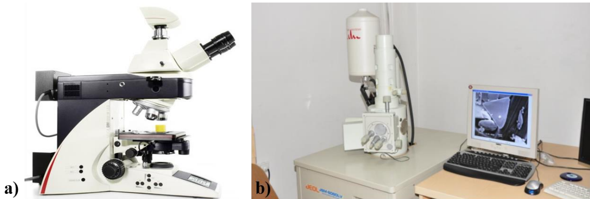
Resim 7.19. Makro-mikroyapı analizlerinde kullanılan mikroskoplar a) optik mikroskop, b) elektron mikroskobu
