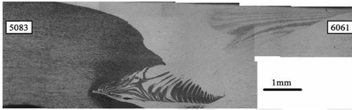
Resim 6.7. AA 5083/AA6061 çiftinin kaynak sonrası mikroyapı görünümü [182]
