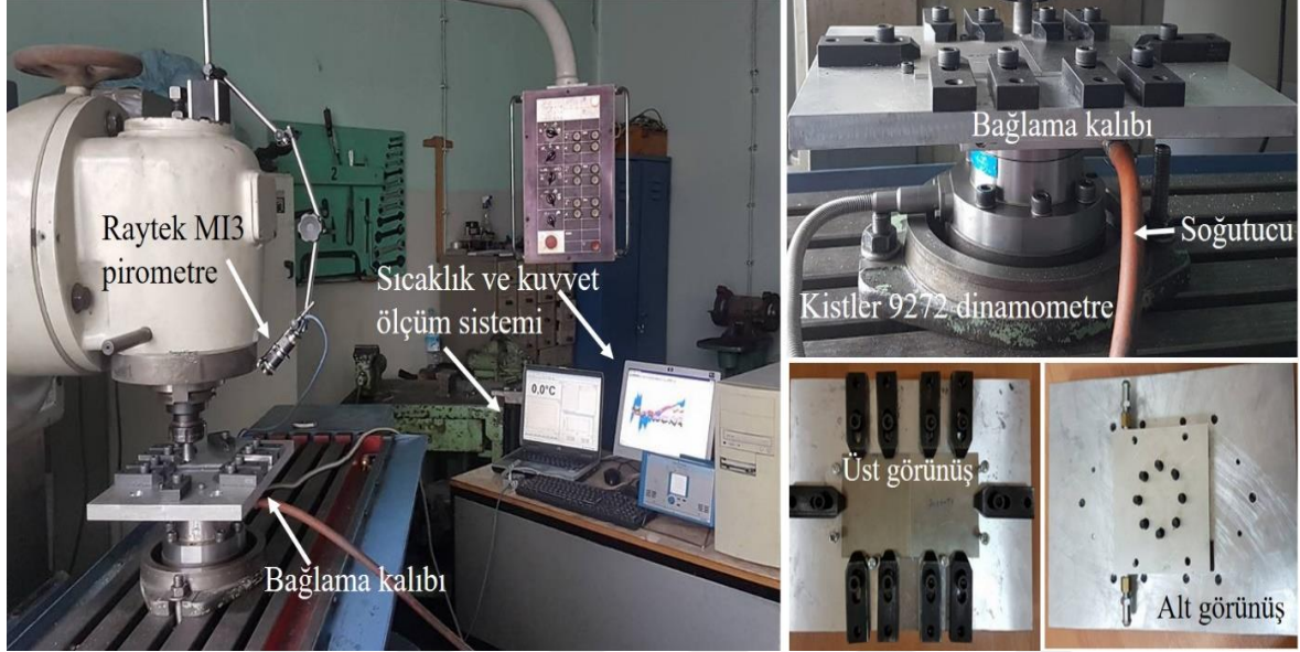
Resim 7.1. Ön kaynak işlemleri düzeneği ve bağlama kalıbının genel görünümü
