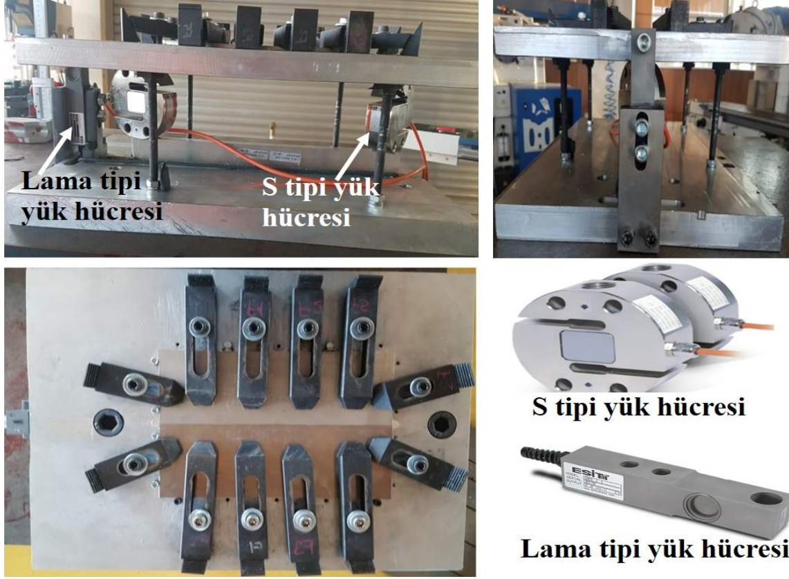
Resim 7.8. Geliştirilmiş ön kaynak işlemlerinde için geliştirilen birincil bağlama kalıbı ve yük hücrelerinin görünüşü
