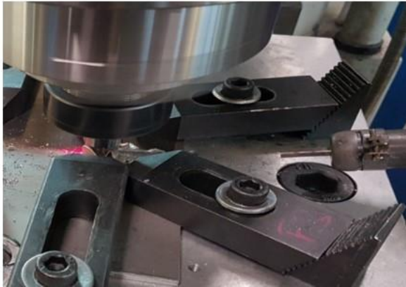
Resim 7.12. Sıcak hava üfleme ve sıcaklık ölçüm sisteminin SKK düzeneğine konumlanması
