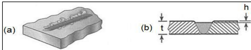
Şekil 6.17. Metal taşması sonucu a) Yüzey görünümü, b) Kesit görünümü [197]
