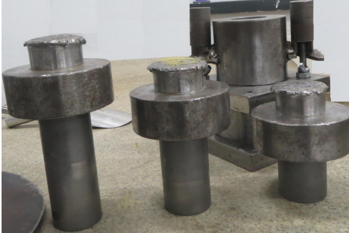
Resim 3.1. Çalışmada numunelerin sıkıştırılmasında kullanılan aparat
