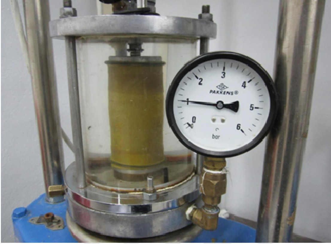
Resim 3.3. Sıkıştırılan ve hazırlanan numunenin UU üçeksenli basınç deneyi cihazına yerleştirilmesi
