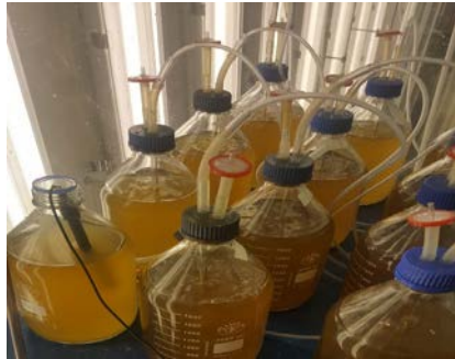
Şekil 2.2. Nitrifikasyon bakterileri ilaveli veya ilavesiz farklı azot ortamlarında algleri yetiştirme düzeneği.
