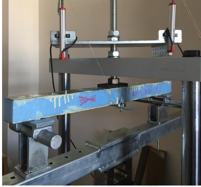
Şekil 3.11. Üç nokta eğilme testi düzeneği
