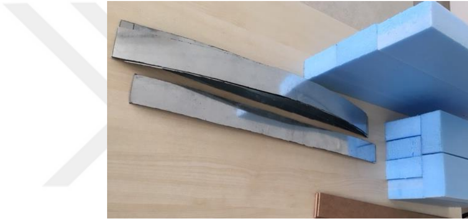
Şekil 3.10. Üç nokta eğilme testi için kesilmiş köpük ve sac
