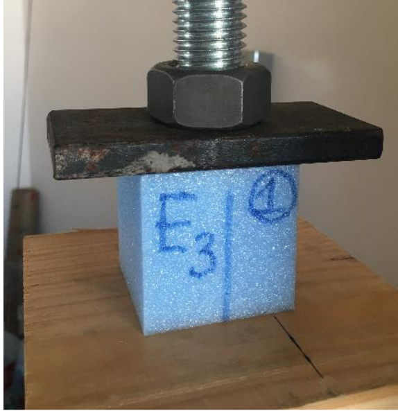
Şekil 3.5. XPS köpüğün basit basınç testi düzeneği
