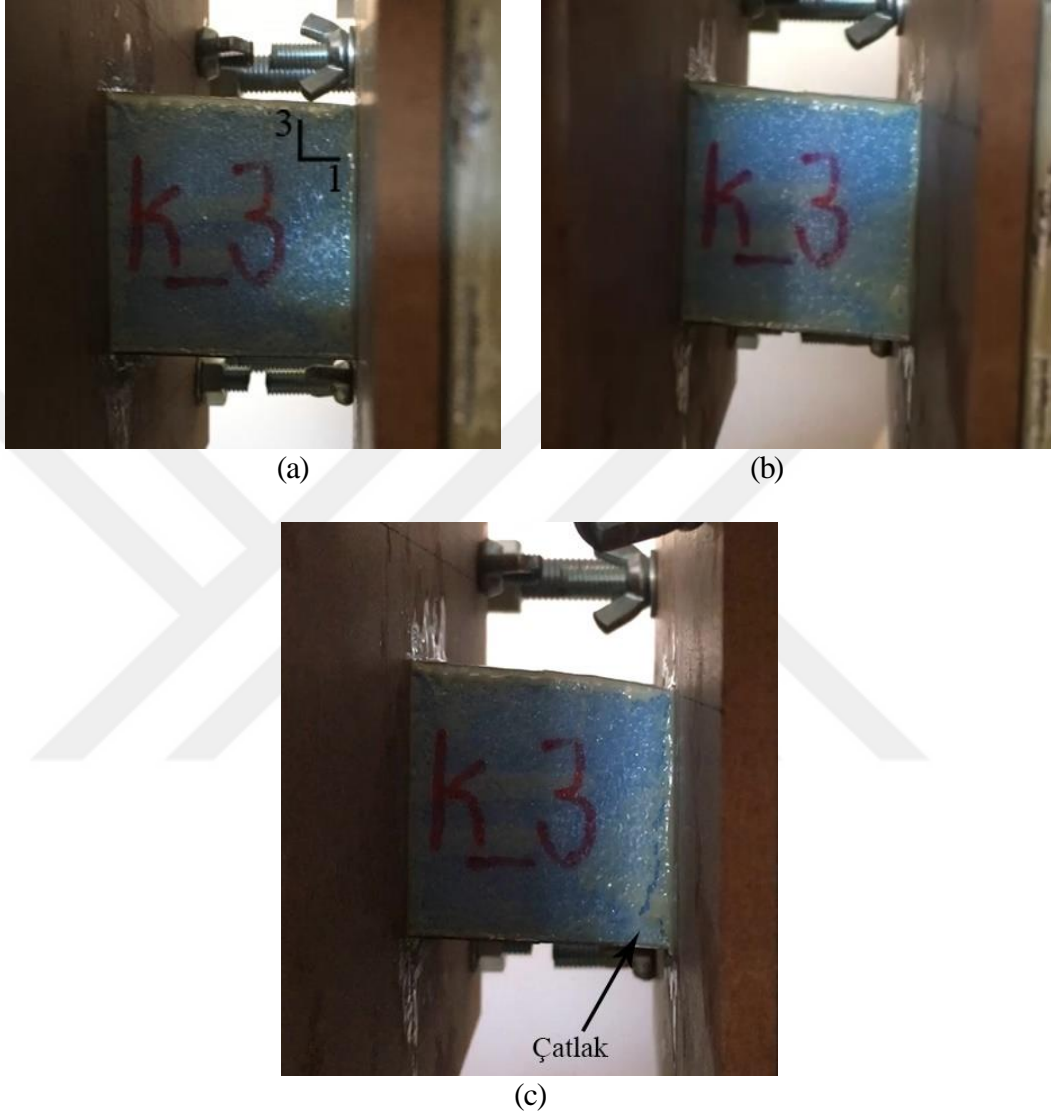
Şekil 4.24. K/Güçlendirilmiş_3 numunesinin (a) test öncesi (b) test sırasında (c) göçme sonrası görüntüleri
