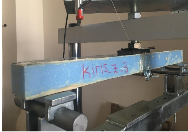
Şekil 3.24. Üç nokta eğilme testi numunesinin mesnet ve yüklenme detayı
