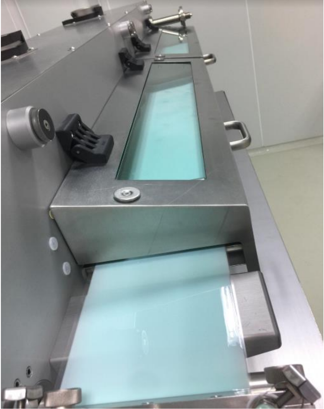
Şekil 3-6: Pilot üretim cihazının kurutma kabinleri
