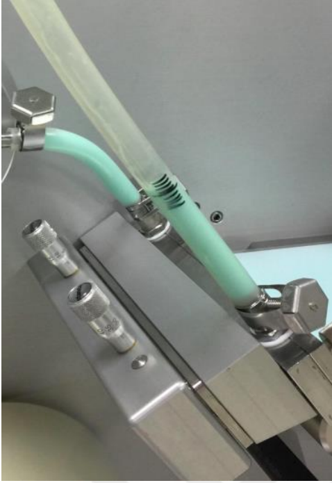
Şekil 3-4: Pilot üretim cihazının haznesi ve kalınlığı ayarlamak için kullanılan vidalar
