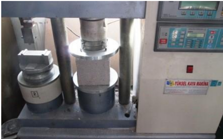
Resim 3.16 rneklerin basın presinde kırılması.
