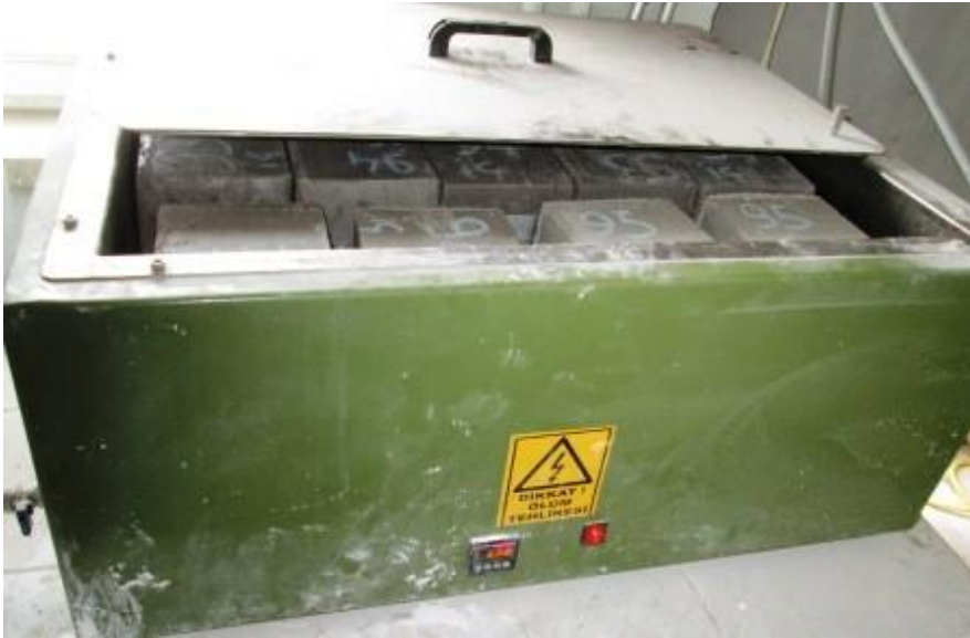
Resim 3.14 Örneklerin buhar kürüne alınması.
