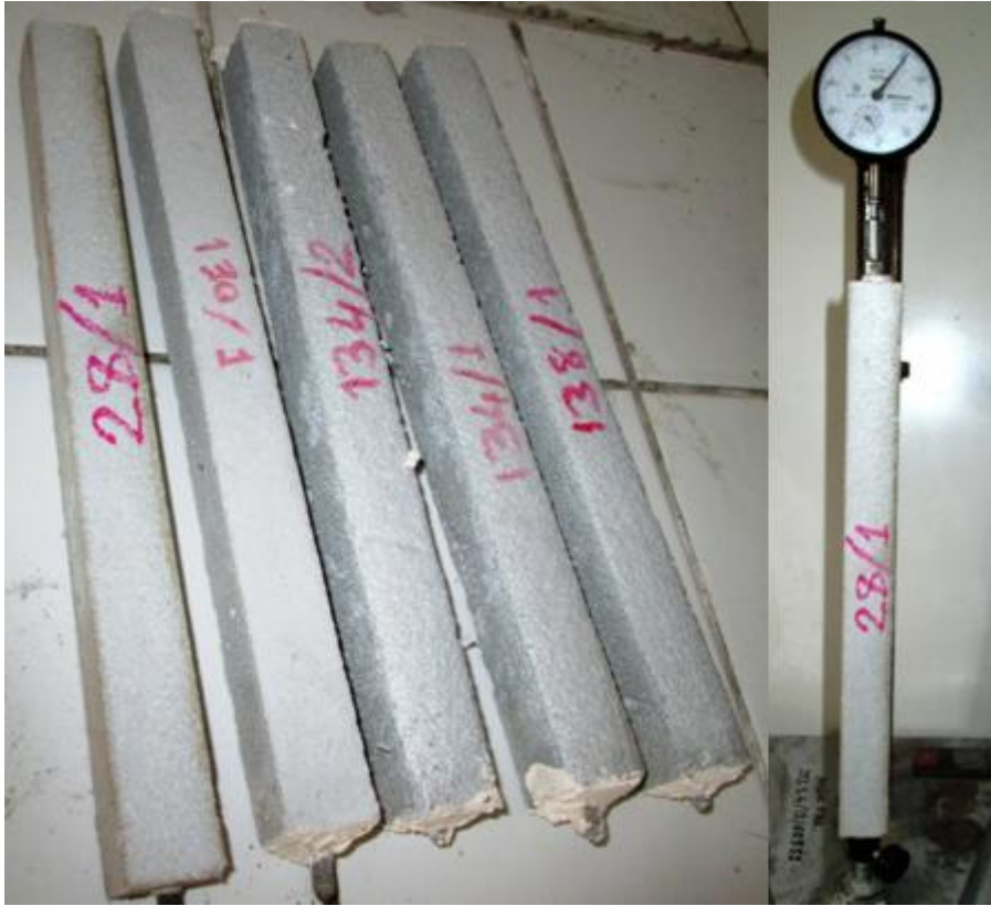
Resim 3.23 Boy değişimi ölçümü için üretilen harç örnekleri ve ölçüm işlemi.
