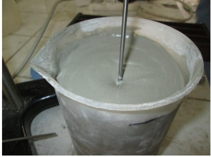
Resim 3.19 Viskozite ölçüm örneği.
