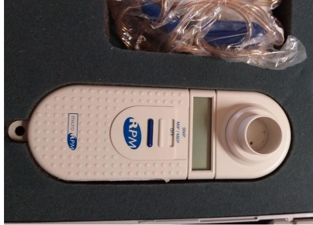
Resim 3. MIP ve MEP değerlerinin ölçüldüğü elektronik ağız basınç ölçüm cihazı
