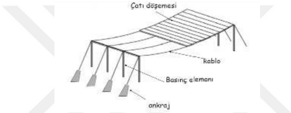
Şekil 3.19. Tek tabakalı paralel kablo kirişli çatı sistemi(Urfalı, 2012)
