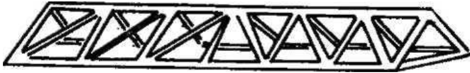
Şekil 3.0.28. Betonarme uzay kafes
