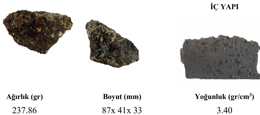
Şekil 5.17: SW- 17 kod numaralı örneğin ve iç yapısının makro görünümü ile fiziksel özellikleri
