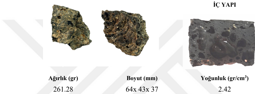
Şekil 5.18: SW- 18 kod numaralı örneğinin ve iç yapısının makro görünümü ile fiziksel özellikleri
