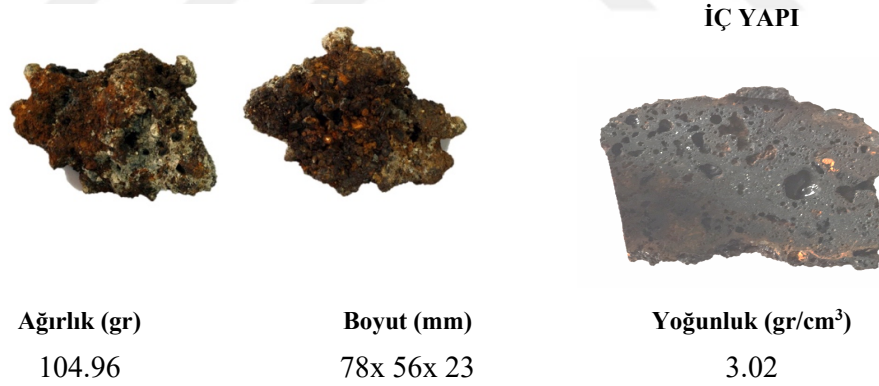
Şekil 5.5: NE- 4 kod numaralı örneğin ve iç yapısının makro görünümü ile fiziksel özellikleri
