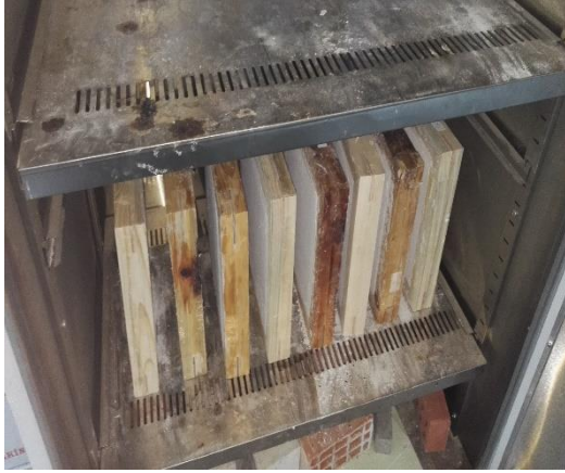
Resim 3.9. Kür işlemi yapılan paneller
