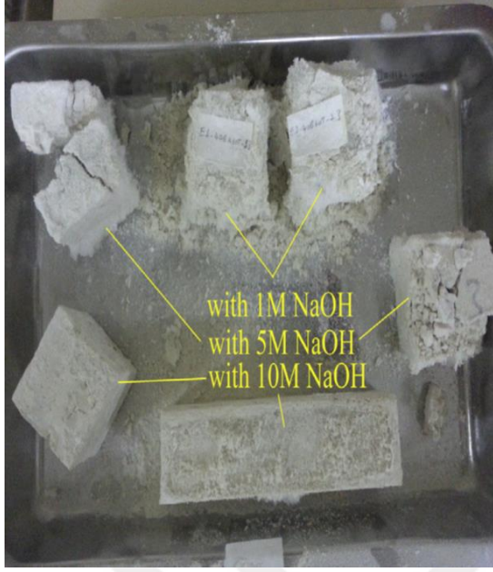
Resim 2.14. NaOH derişiminin panellerin sertliğine etkisi (Tekin, 2016)
