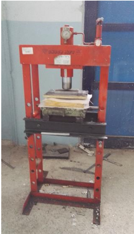
Resim 3.8. Hidrolik pres makinesi ( \pm 10 N hassasiyetli)
