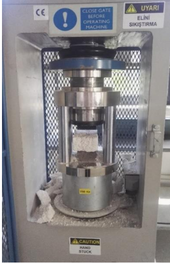
Resim 3.14. Basınç dayanımı ölçüm cihazı
