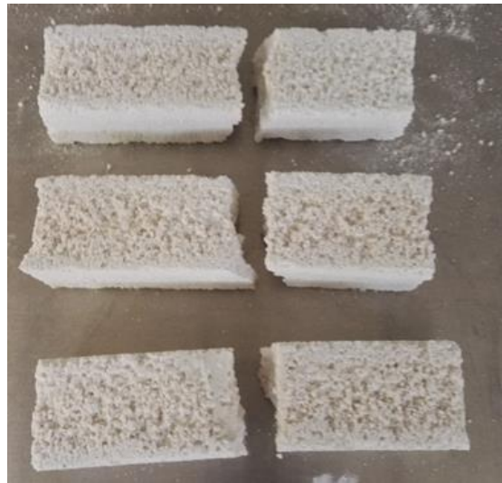
Resim 3.13. a) Panel basınç dayanım testi hazırlığı b) 6 parçaya ayrılan panel
