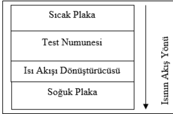
Şekil 3.3. Hot Plate çalışma prensibi
