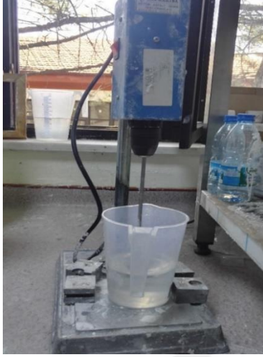
Resim 3.5. Geopolimer bağlayıcının hazırlanması
