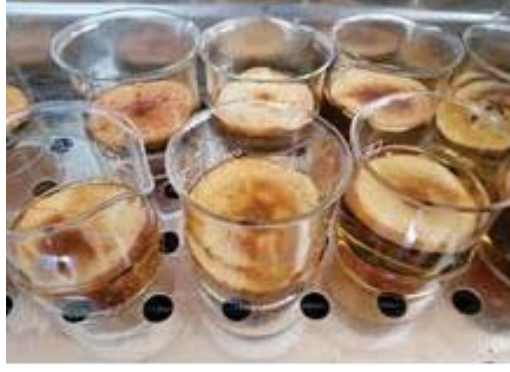
Şekil. 3.14. Kurutulmuş elma dilimlerinde geri su alma testi
