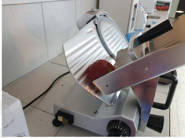
Şekil 3.2. Paslanmaz çelikten imal edilmiş meyve dilimleme makinesi
