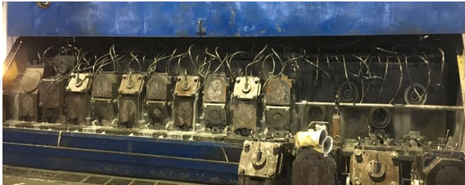
Şekil 3.4. Döküm Prosesi Haddeleme Ünitesi
