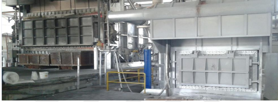
Şekil 3.1. Döküm Prosesi Ergime ve Dinlendirme Fırınları
