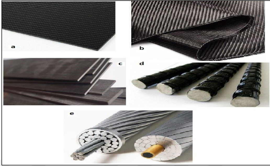
Şekil 2. 10 Karbon esaslı polimer türleri a) levha, b) kumaş, c) şerit, d) donatı çubuğu, e) öngermeli tendon
