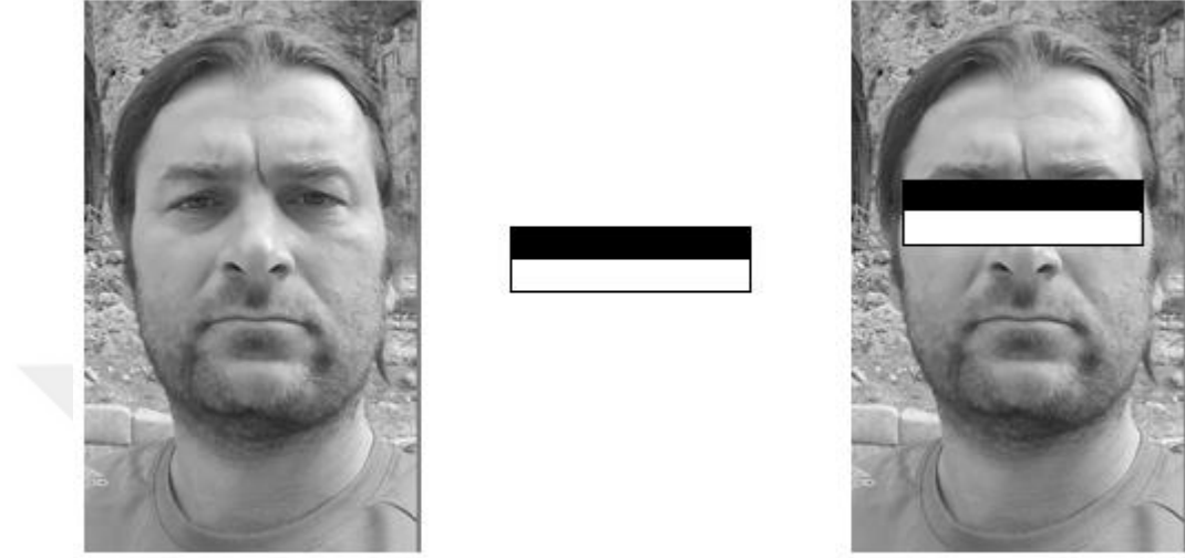
Şekil 3.37. Haar cascade kenar öznitelik çerçevesi ile göz kısmının bulunması
