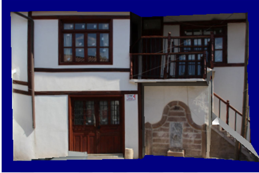
Şekil 3.29: Konya Çalışma Sahası Yersel Fotogrametri İle Binanın Batı Cephesine Ait Texture İşlemleri
