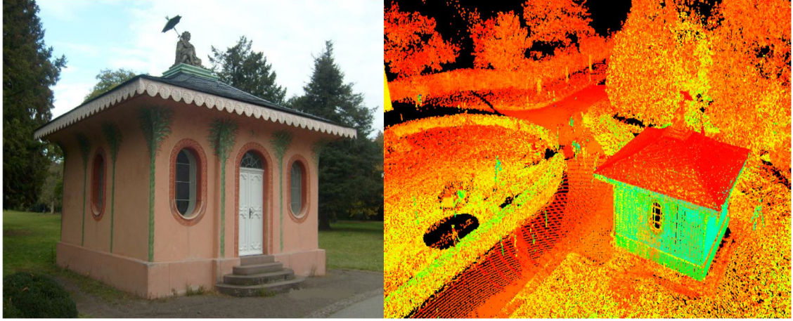
Şekil 2.60: Çin Çay Evi'nin YLT ile Modellenmesi(Kuçak, 2013)
