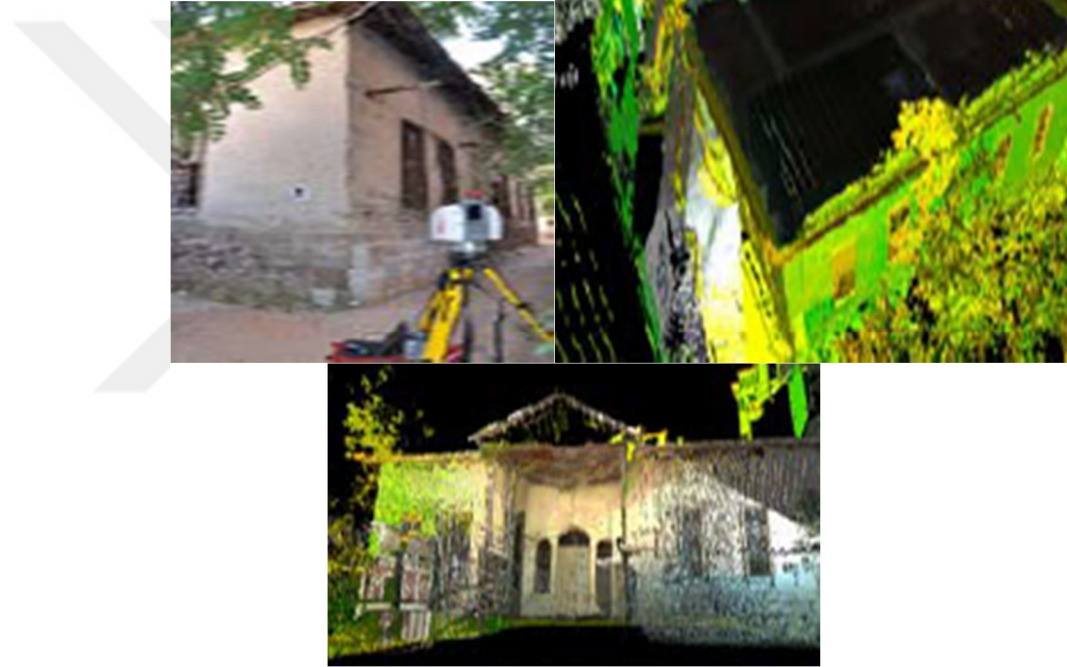
Şekil 2.59: Sivil Mimari Eserin YLT ile 3B Modellenmesi, Üstte Soldan Sağa Yersel Lazer Tarama Aleti, Nokta Bulutunun Perspektif Görüntüsü, Altta Nokta Bulutunun Güney Cephesi (Korumaz, 2016)
