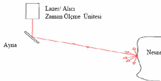
Şekil 2.46: Uçuş Zamanlı Yersel Lazer Tarayıcı Çalışma Prensibi
