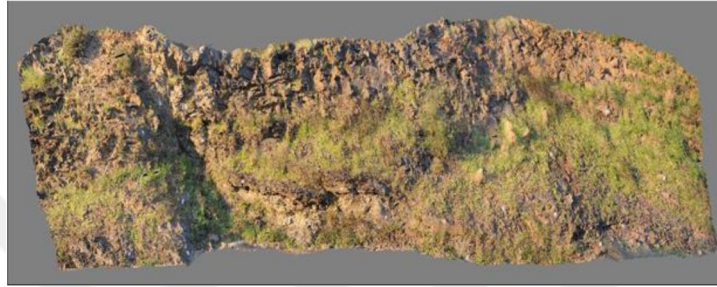
Şekil2.21: Kayaç Yüzeylerinin Hacim Hesaplanması İçin Oluşturulan 3B Mesh (İncekara, 2016)
