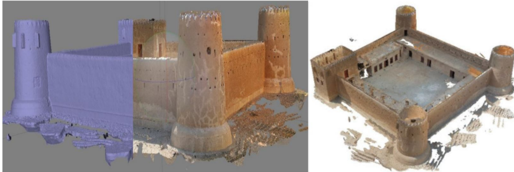
Şekil 2.38: Al Zubarah Kalesi'nin Yersel Fotogrametri Yöntemi İle Agisoft Programında Üretilmiş 3B Modeli (Kersten ve ark., 2015)
