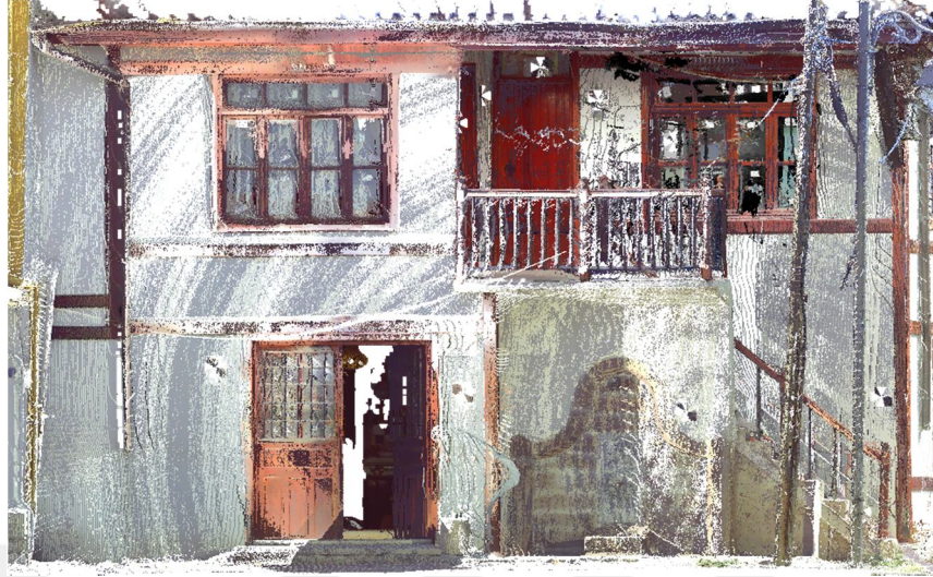
Şekil 3.14: Konya Çalışma Sahası Yersel Lazer Tarama İle Binanın Batı Cephesine Ait Ortofotosu
