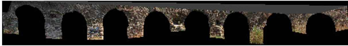
Şekil 3.40: Antalya Çalışma Sahası Su Kemerinin Yersel Fotogrametrik Yöntemle Elde Edilen Ortofotosu
