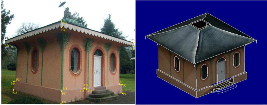
Şekil 2. 30: Solda Çin Çay Evine Ait Kontrol Noktaları, Sağda PhotoModeler Programı İle Oluşturulan 3B Model.(Kuçak, 2013)
