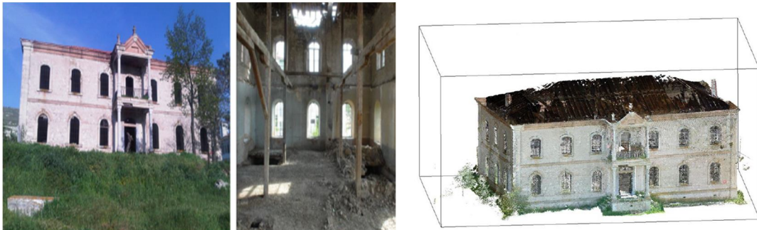
Şekil 2.62: Eskişehir'in Seyitgazi İlçesinde Bulunan Eski Askerlik Şubesinin YLT ile İzlenilmesi Solda Askerlik Şubesi, Sağda YLT ile Üretilmiş 3B Model (Çömert ve ark., 2012)
