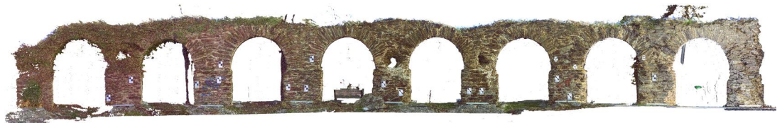
Şekil 3.35: Antalya Çalışma Sahası YLT Sonucu Elde Edilen Ortofoto Yersel Fotogrametri Yöntemi İle Yapılan Modelleme
