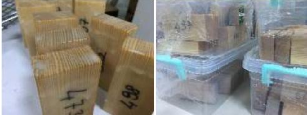
Şekil 5.6 Parafinlenmiş Ahşap Bloklar
