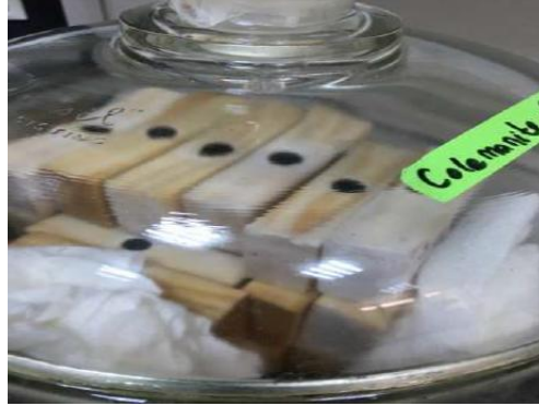
Şekil 5.8 Numuneler 7, 30, 60 ve 90 Gün Kadar Desikatör İçerisinde Kondisyonlama Odalarında Bekletilmesi
