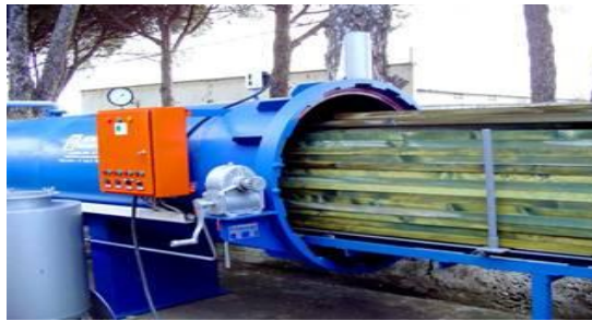
Şekil 3.4 Basınçlı Emprenye Yöntemi [54]
