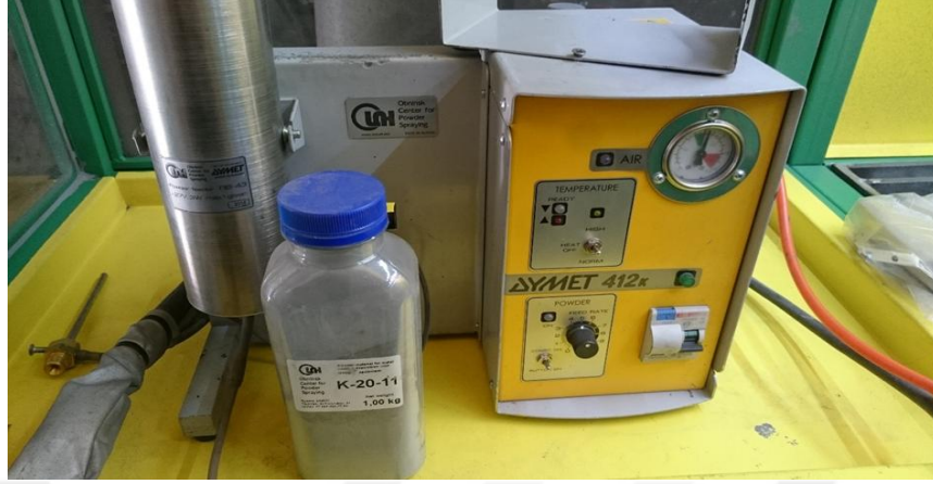
Şekil 3.1. Çalışmalarda kullanılan DYMET firmasına ait 412K model düşük basınçlı soğuk püskürtme cihazı
