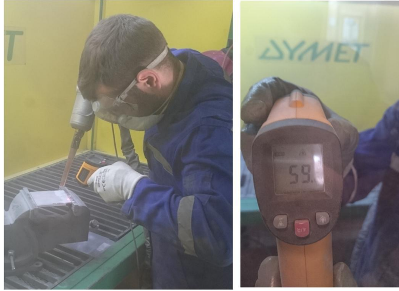
Şekil 4.16. Deneysel çalışmalar sırasında kızılötesi ışınlar ile sıcaklık ölçümünün yapılması
