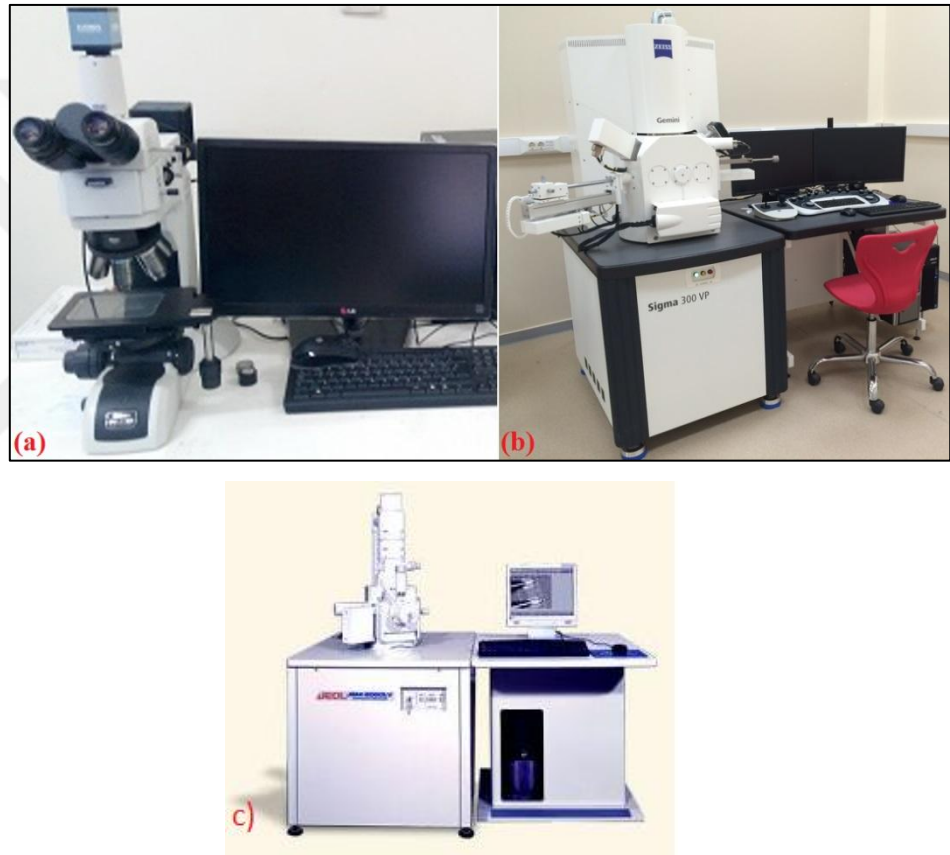
Şekil 3.2. Nikon LV 100 optik mikroskobu (a), Carl Zeiss 300VP taramalı elektron mikroskobu (b) ve Jeol JSM 6060 taramalı elektron mikroskobu
