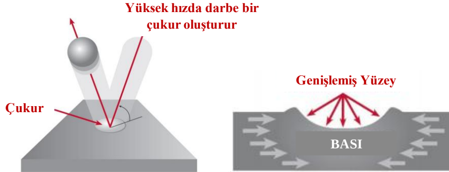
Şekil 2.15. Yüzeye çarpan bir bilyanın yarattığı etkiler
