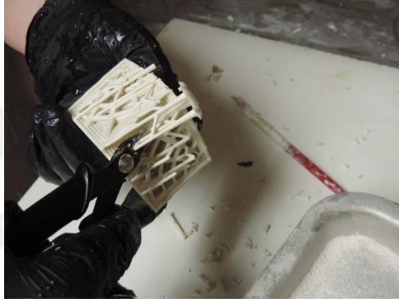
Görsel 3.28. SLA yöntemiyle üretilen formun destek parçalarından ayrılması, Tethon 3D firması Kaynak: Emre CAN fotoğraf arşivi
