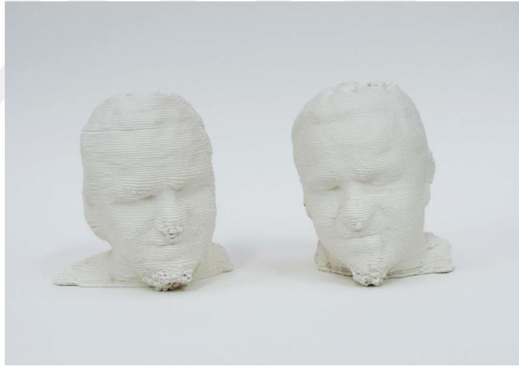
Görsel 3.12. FDM yöntemiyle üretilen objeler, 1200°C Kaynak: Emre CAN fotoğraf arşivi
