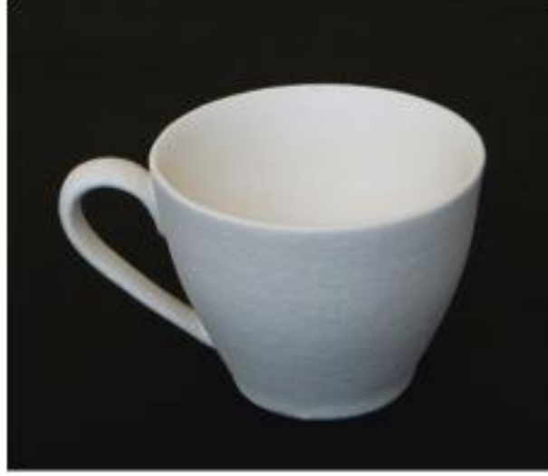
Görsel 3.15. Toz bağlama yöntemi ile şekillendirilmiş ve pişirilmiş fincan, Bristol Araştırma Merkezi (Centre for Fine Print Research)
