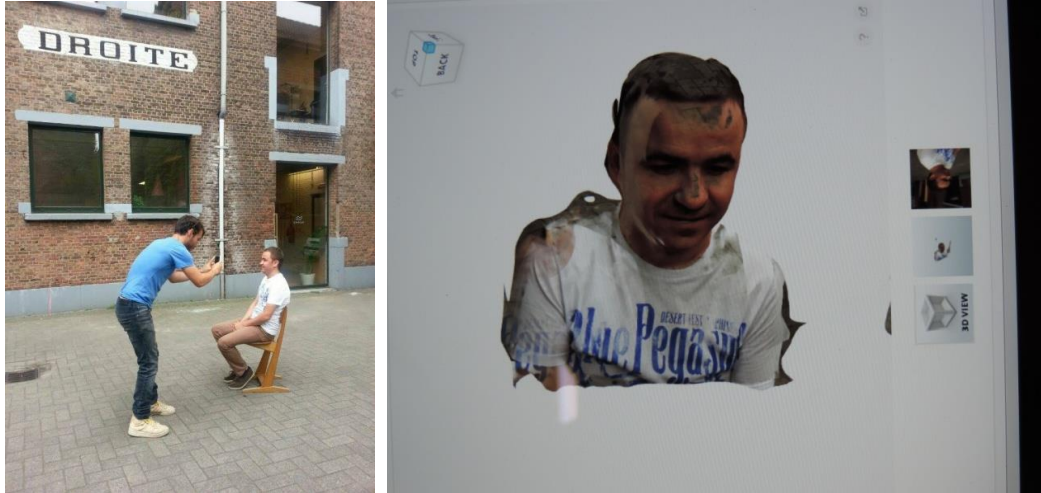
Görsel 3.8. Modelin farklı açılardan fotoğrafının çekilerek bilgisayar ortamına aktarılması Kaynak: Emre CAN fotoğraf arşivi
