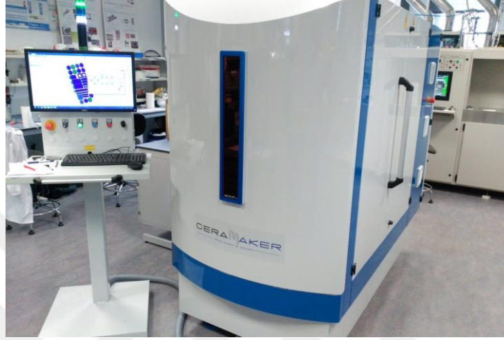
Görsel 3.23. “Ceramaker” SLA üç boyutlu yazıcı 3DCeram firması
