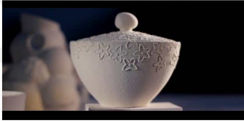
Görsel 3.14. Toz bağlama yöntemiyle şekillendirilmiş kapaklı form, Bristol Araştırma Merkezi (Centre for Fine Print Research)
