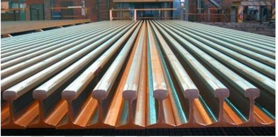
Şekil 6.2: 49E1 mantar (vinyol) ray resmi [34].
