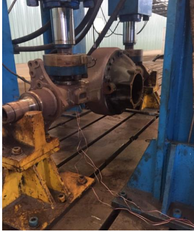
Şekil 5.5 : Arka aks kovanı test rigi.
