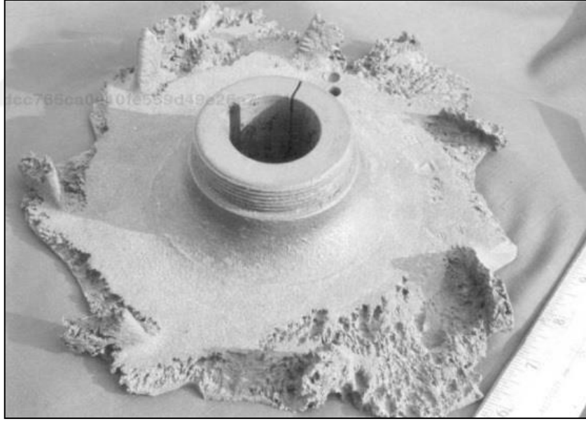
Şekil 3.18: Döküm çelikten üretilmiş pompa çarkının kavitasyonu (URL-1).
