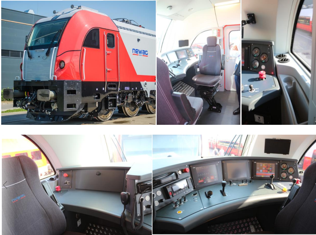
Şekil 4.3 : Newag Dragon lokomotifinin dış stili ve makinist kontrol masası.
