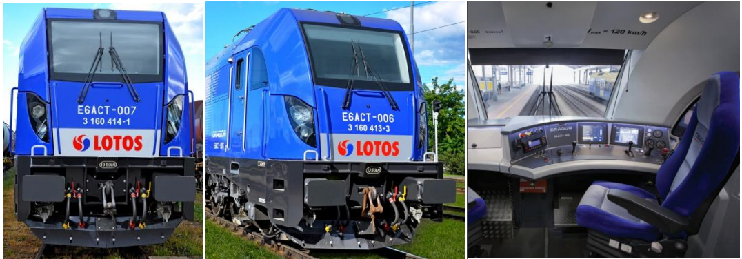
řekil 4.2 : Newag Dragon lokomotifinin dıř stili ve makinist kontrol masası.
