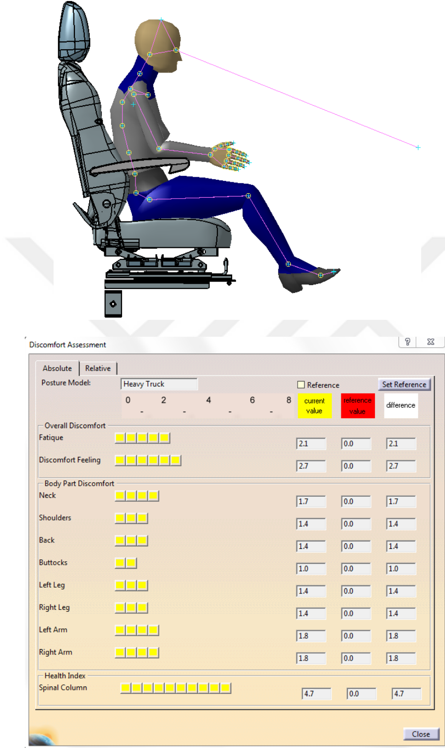
Şekil 5.23 : %5’lik Türk kadın kullanıcının 10° sırt açısı ile koltuk SgRP noktasına göre oturtulması ve konfor analizi.
