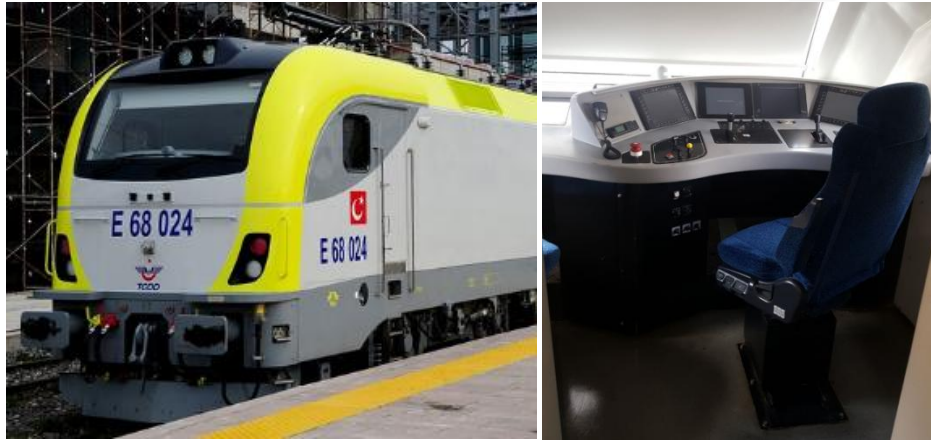
Şekil 4.6 : Tülomsaş E68000 lokomotifinin dış stili ve kontrol masası.
