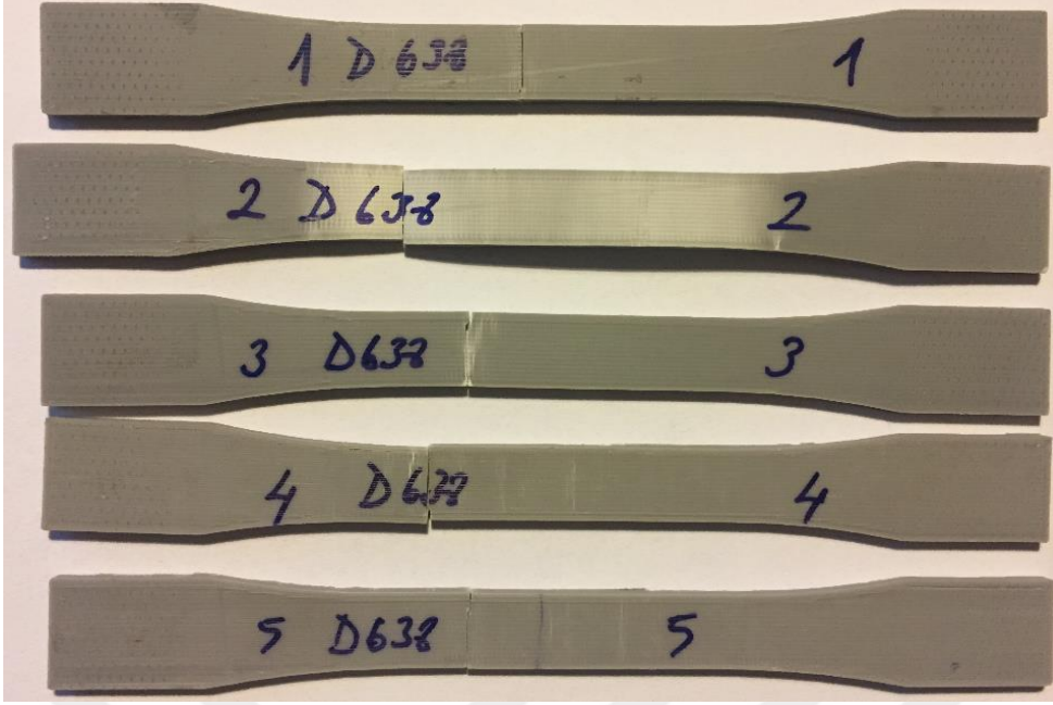
Şekil 4.1. Performance ABS çekme numunelerine ait deformasyonlar
