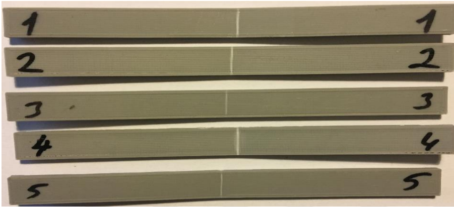
Şekil 4.11. Performance ABS eğilme numunelerine ait deformasyonlar
