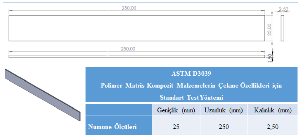
Şekil 3.11. ASTM D3039 çekme testi numune ölçüleri ve 3B modeli (ASTM D3039/D3039M, 2017)
