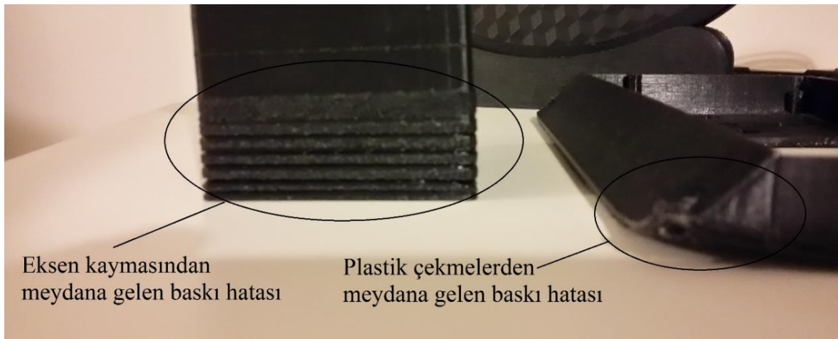
Şekil 3.3. Uzun süreli baskılarda meydana gelen hatalar
