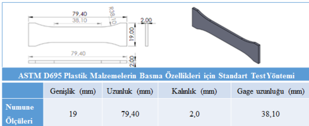
Şekil 3.13. ASTM D695 basma testi numune ölçüleri ve 3B modeli (ASTM D695, 2015)
