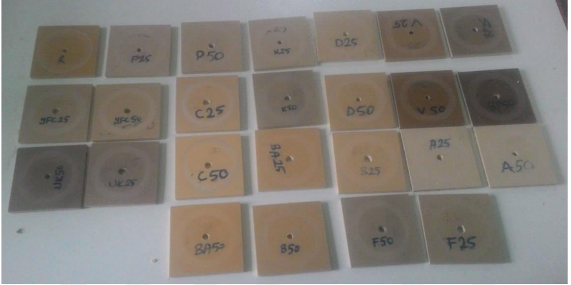
Şekil 4. 29 PVC kompozit numunelerin aşınma testi sonrası görünümü
