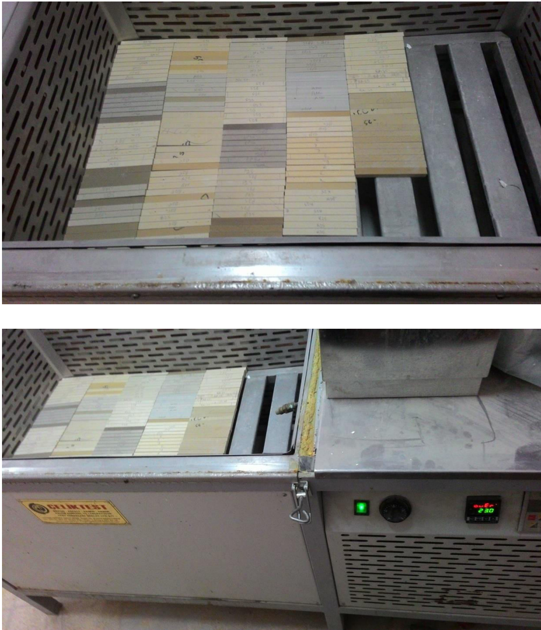
řekil 3. 12 PVC kompozitlerin 48 saat 23  C’de ve %50 baęıl nemde řartlandırılması
