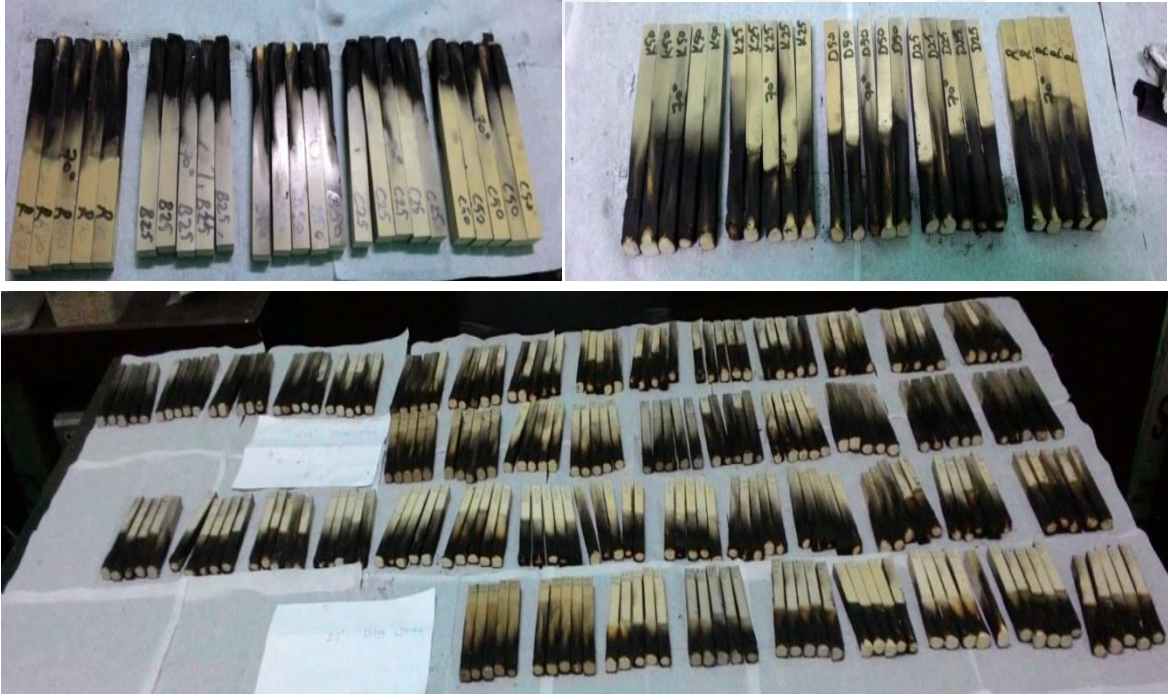
Şekil 4. 8 PVC kompozitlerin dikey yanma testi sonrası görünümü
