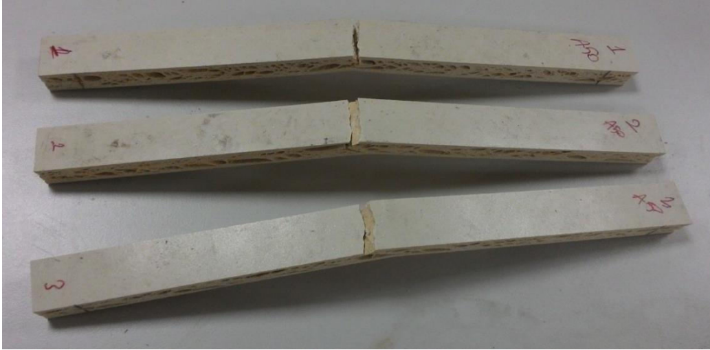
Şekil 4. 13 A50 numunesinin eğilme testi sonrası görünümü
