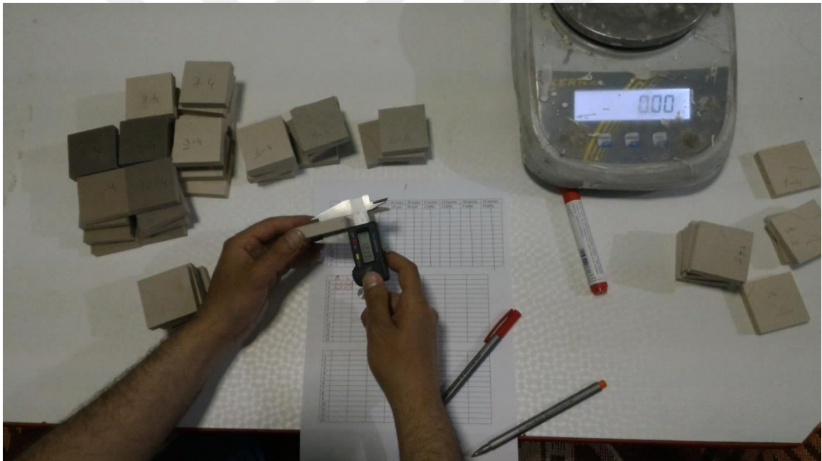
Şekil 3. 9 PVC kompozit numunelerin boyutlarının ölçülmesi ve tartılması
