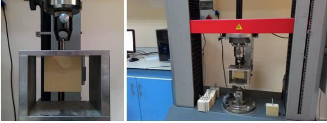
Şekil 3. 26 Numune yüzeyine paralel yönde vida çekme deneyi
