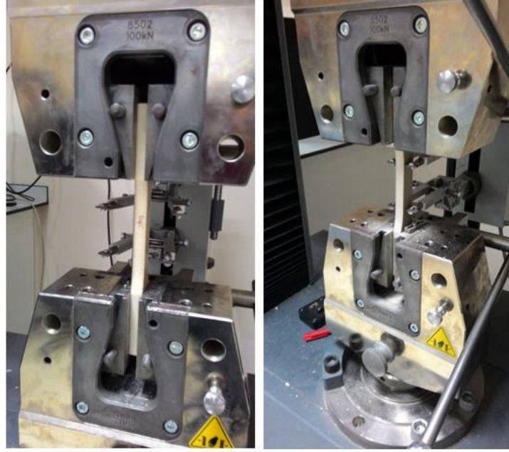
Şekil 3. 23 Çekme deneyinde uzamaların tespiti için ekstansometreye konulması
