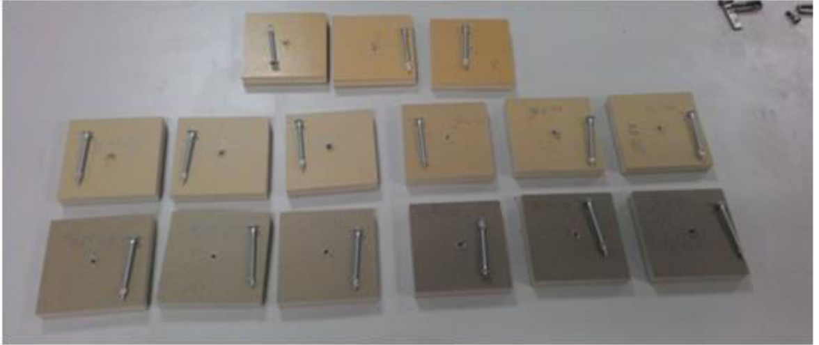
Şekil 4. 23 Numunelerin yüzeye dik çekme vida tutma gücü testi sonrası görünümü
