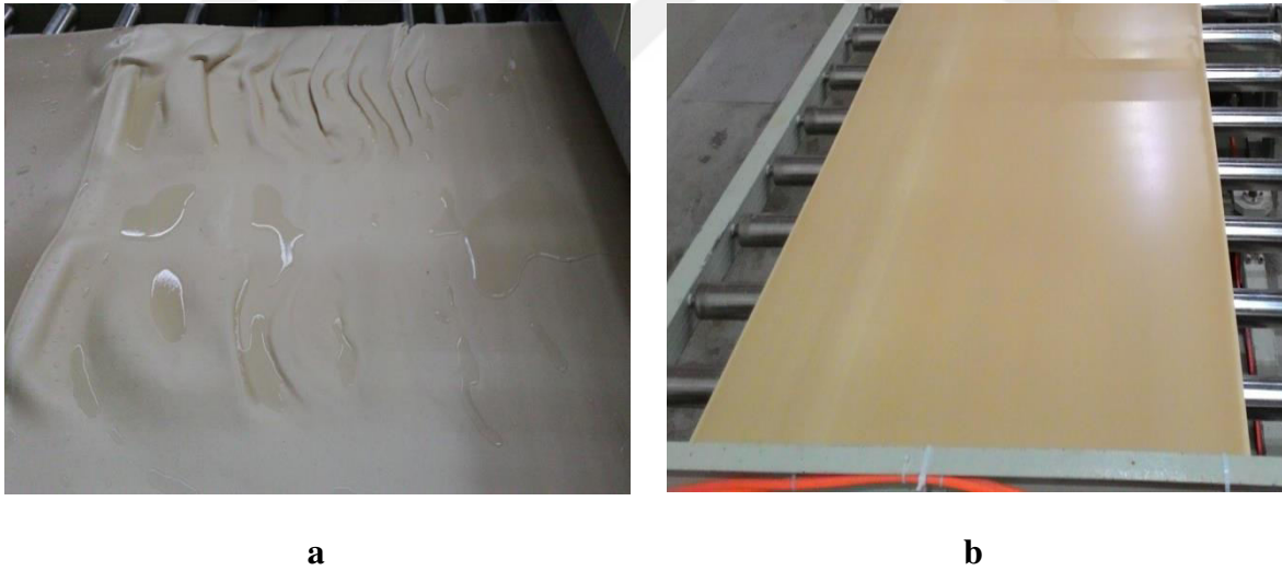
Şekil 3. 6 Hatalı karışım (a) ve referans karışım (b) örnekleri
