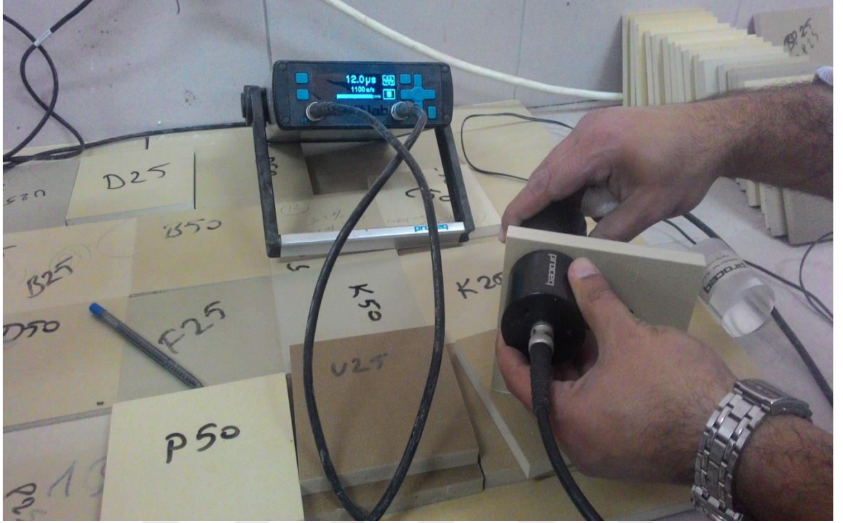
Şekil 3. 10 PVC kompozit numunelerin ultrases hızının ölçülmesi
