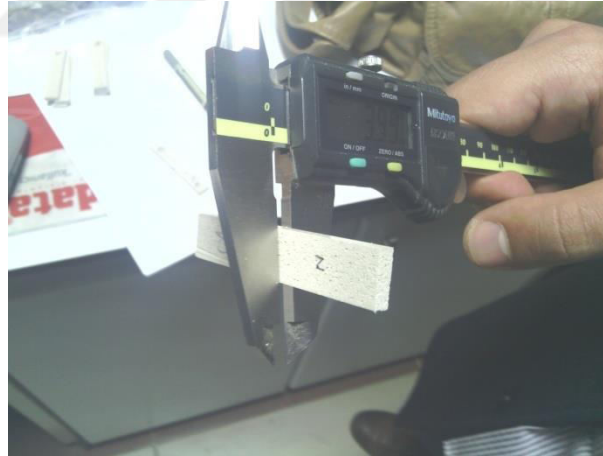
Şekil 3. 29 Numunelerin dijital kumpas ile kalınlıklarının ölçülmesi
