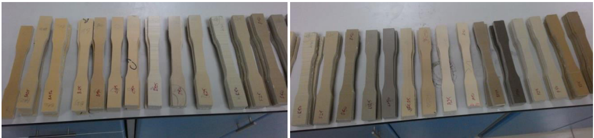
Şekil 3. 22 ASTM D638'e göre PVC kompozit çekme numuneleri
