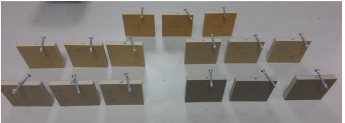
Şekil 4. 24 Numunelerin yüzeye paralel çekme vida tutma gücü testi sonrası görünümü
