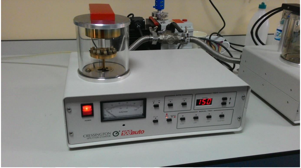
Şekil 3. 34 Kompozit numunelerde alınan parçalara altın kaplama yapılması
