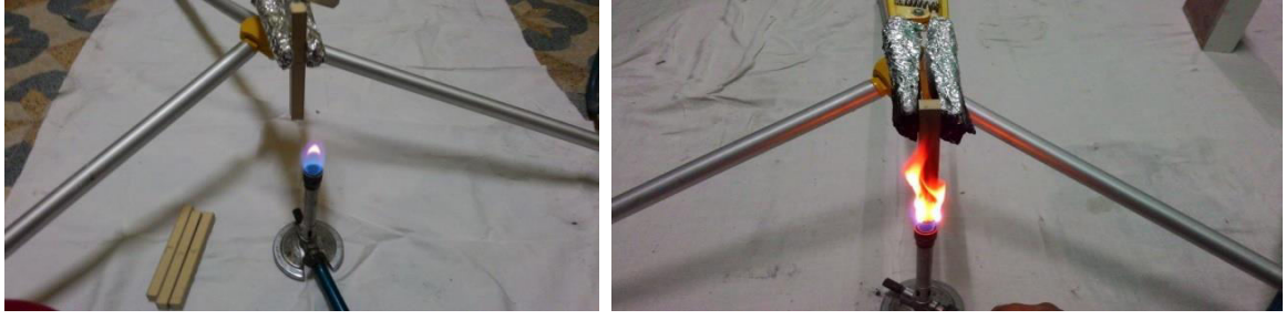
Şekil 3. 14 PVC kompozitlere dikey yanma testi uygulanması
