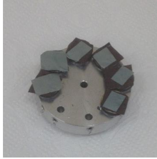
Şekil 56- Altın kaplama işlemi sonrası nanolif yüzeylerin görünüşü
