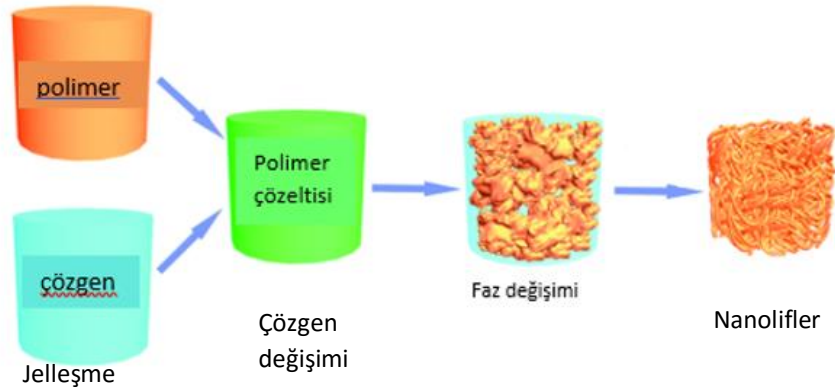
Şekil 3-Faz değişimi yönteminin şematik gösterimi ve çözücü değişimi (He et al., 2014)
