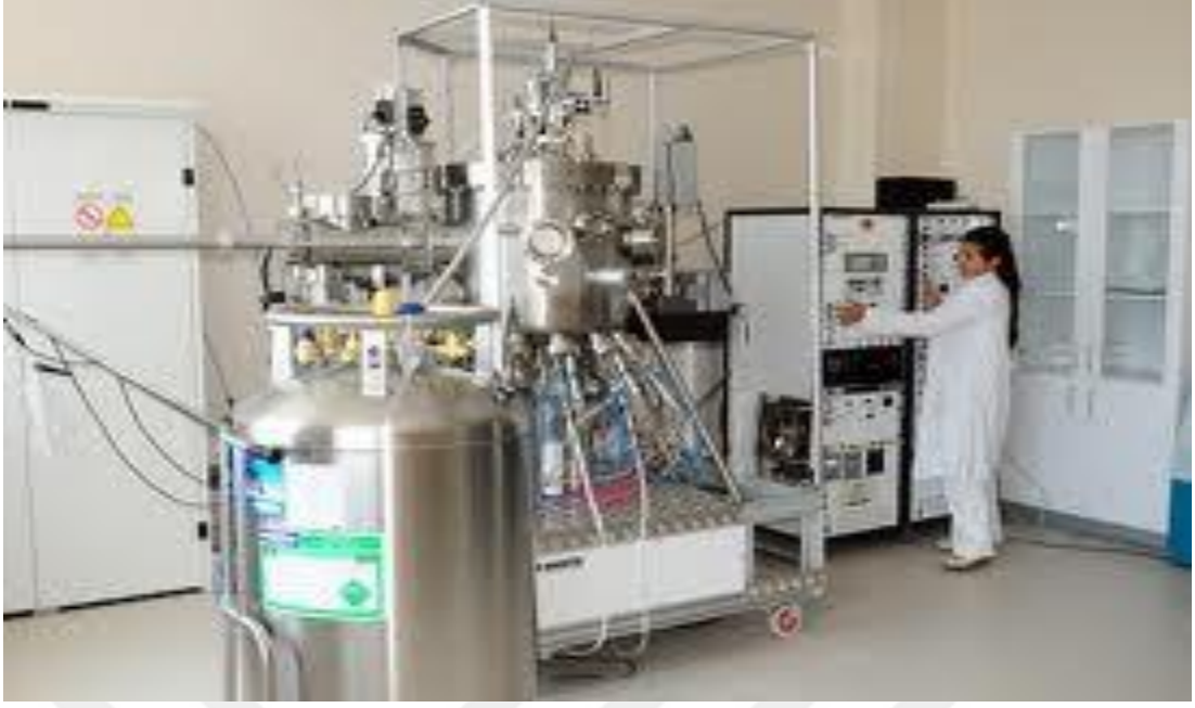
Şekil 2.4: Epitaksiyel büyüme tekniğinde kullanılan cihaz.
